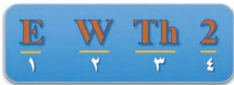
شکل ۱۰- نحوه نام گذاری الکترود تنگستن
