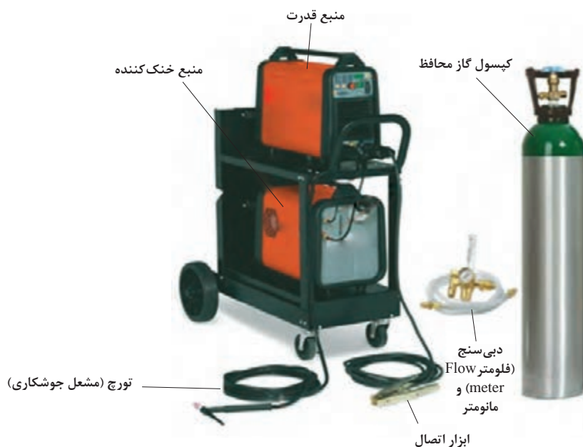
شکل ۲- تجهیزات فرایند GTAW
