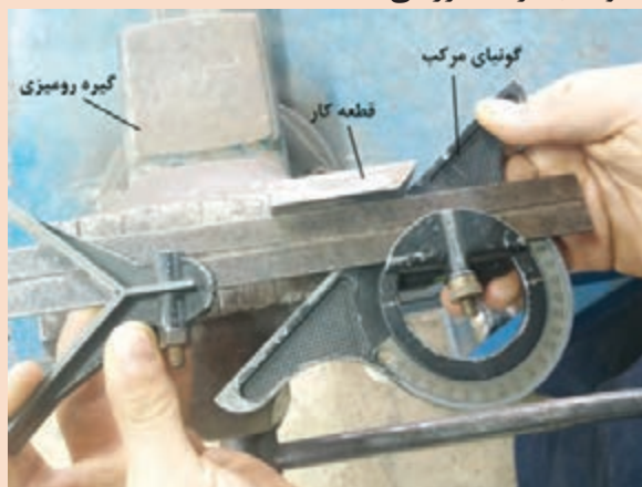
شکل ۲۳- بررسی صحت زاویه با گونیای مرکب
