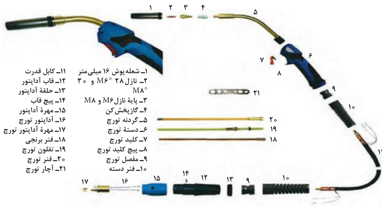
شکل ۷- اجزای تشکیل دهنده تورچ GMAW
