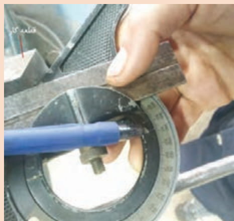
شکل ۲۳- بررسی صحت زاویه با گونیای مرکب
