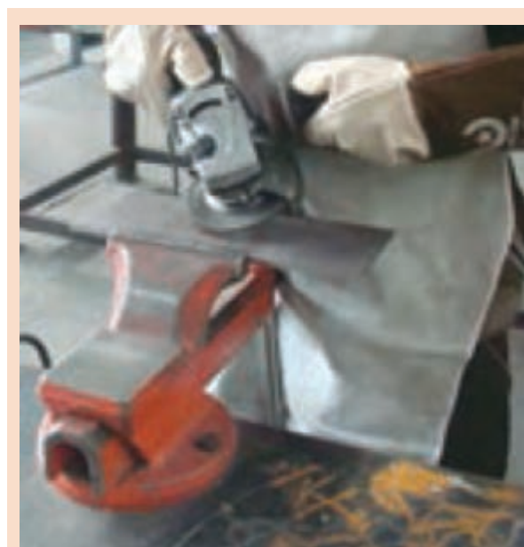
شکل ۱۲- سنگ زدن پشت ورق (ریشه جوش)
