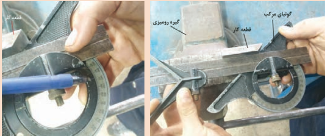
شکل ۲۰- بررسی صحت زاویه با گونیای مرکب
