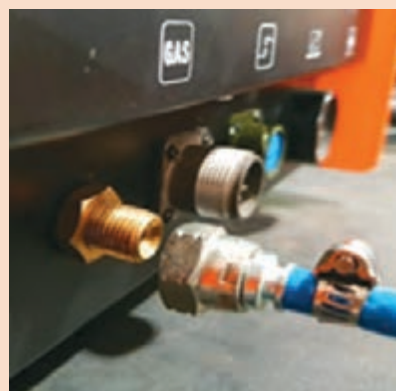
شکل ۶- نصب اتصال گاز محافظ
