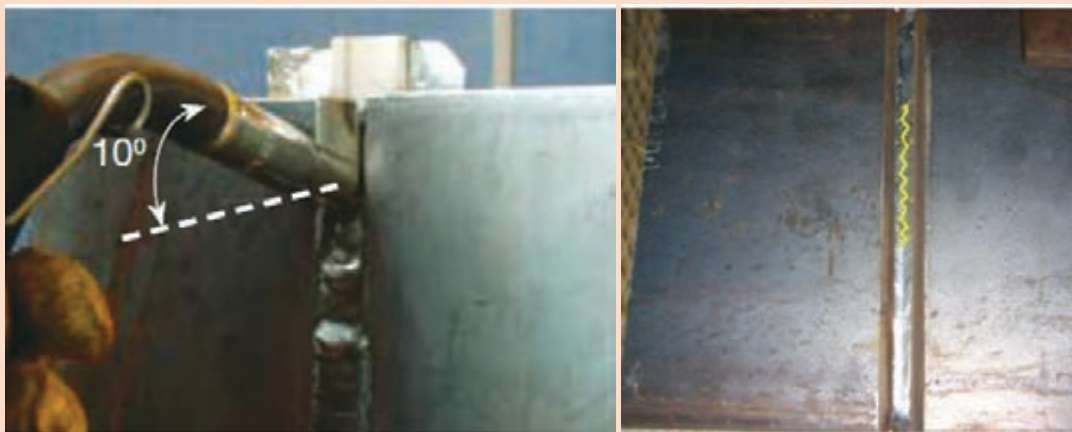
شکل ۲۴- زاویه تورچ و جهت حرکت آن
