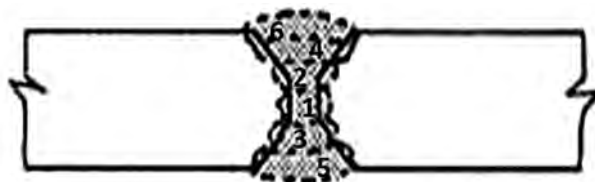
شیار V دو طرفه Double-V Groove (ب)
