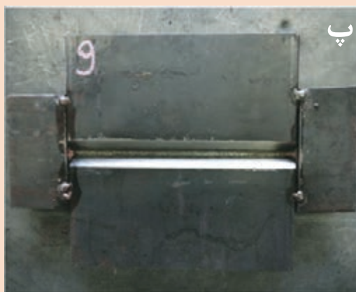
شکل ۱۷- موقعیت دهی و مونتاژ قطعه کار
