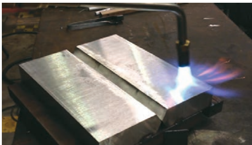
شکل ۵- پیش گرم کردن قطعه ضخیم توسط شعله
