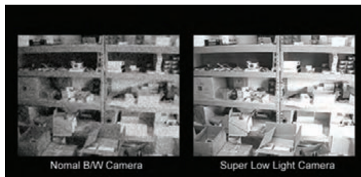
شکل ۱۸- تأثیر مشخصه Minimum Illumination در تصویر
