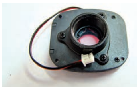
شکل ۱۰- فیلتر IR-CUT
