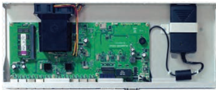
شکل ۴- نمای داخلی مسیریاب میکروتیک
