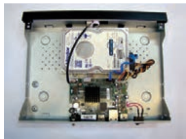
شکل ۲۱- دستگاه باز شده NVR
