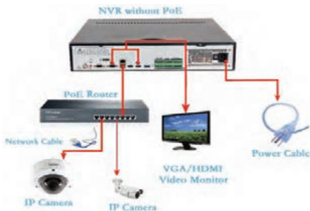
شکل ۱۷- اتصال دوربین به NVR
