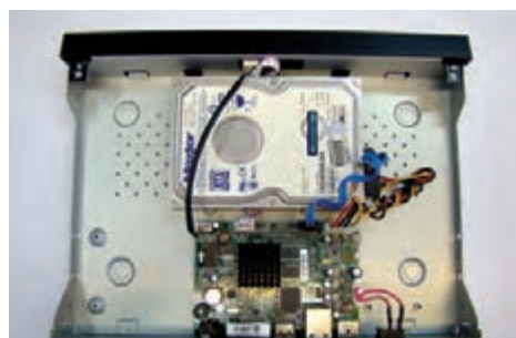
شکل ۳۵- محکم کردن دیسک سخت در محل نصب
