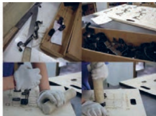
شکل ۱۰۴- قرار دادن تیغ‌ها در قالب
