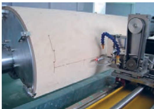
شکل ۱۲۶- برش تخته قالب با دستگاه اره CNC
