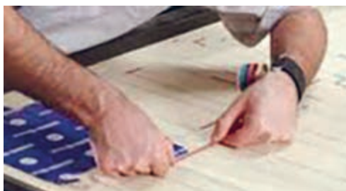
شکل ۹۳- نحوه چسباندن طرح روی قالب
