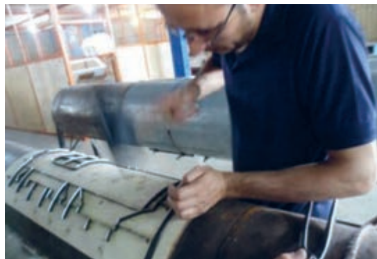
شکل ۱۳۴- جا زدن تیغ‌ها با چکش
