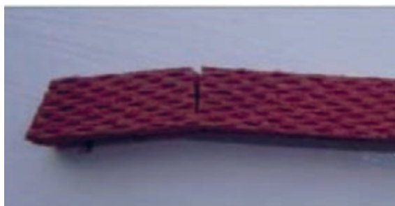
شکل ۱۴۷- لاستیک با درجه شور نامناسب
