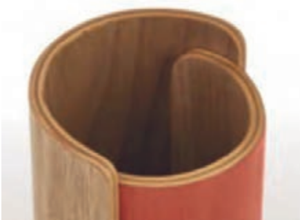
شکل ۱۳- ویژگی انعطاف‌پذیری تخته‌های چند لایه
