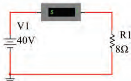
شکل ۷-۴- جریان عبوری از مدار ۵ آمپر است
