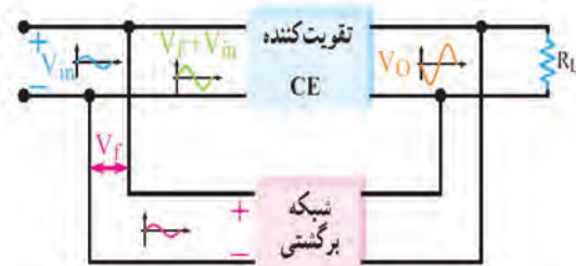
شکل ۱۰-۱۷- بلوک دیاگرام تقویت کننده با فیدبک مثبت
