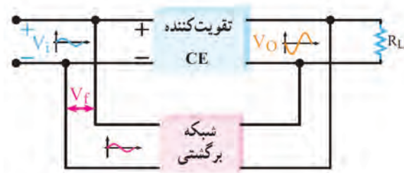
شکل ۱۰-۱۶- بلوک دیاگرام تقویت کننده با فیدبک
