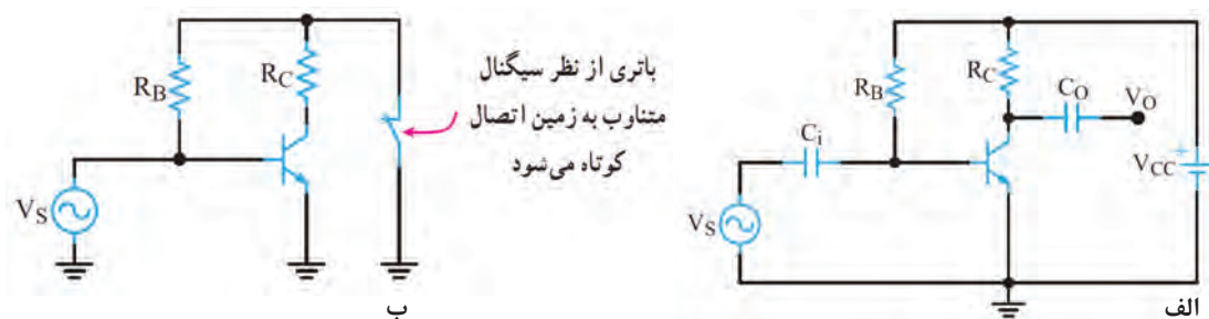
شکل ۱۰-۱۰-۱۱- باتری در برابر سیگنال ac
