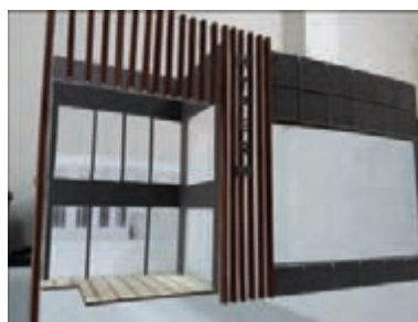
شکل ۵-۸۷- ساخت نمای چوبی: چسباندن برچسب‌های شفاف و ایجاد شیار بر روی آن شکل ۵-۸۸- ساخت نمای شیشه‌ای با استفاده از طلق
