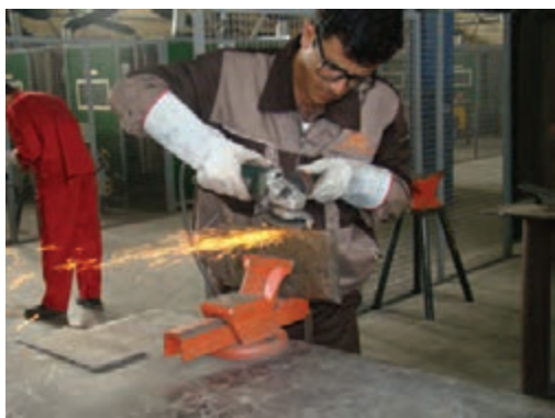
تشخیص نوع فولاد بر اساس آزمایش جرقه
