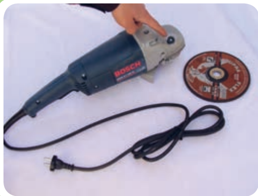
کلید مخصوص قفل کردن محور سنگ
