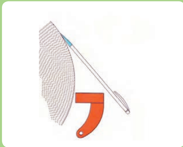
تیز کردن سوزن خط کش
