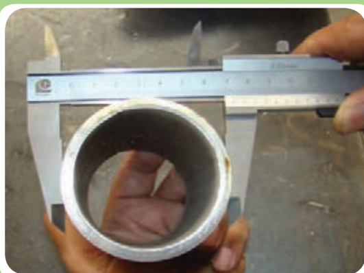
اندازه‌گیری قطر خارجی لوله توسط کولیس
