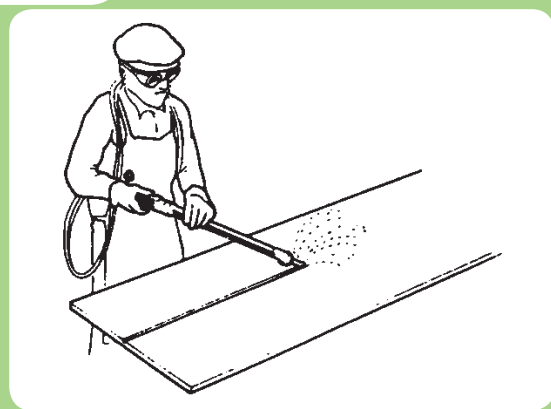
اجرای عملیات برشکاری با مشعل دستی
