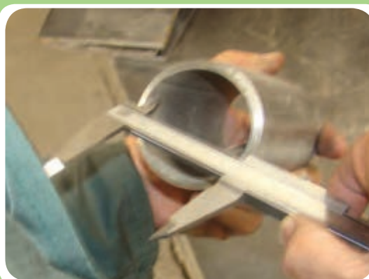
اندازه‌گیری قطر داخلی لوله توسط کولیس
