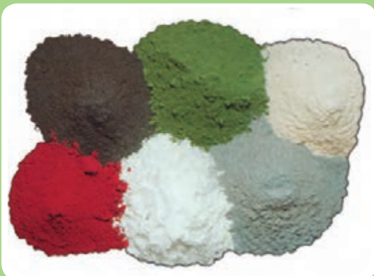
مواد پودری تشکیل دهنده روپوش الکتروده
