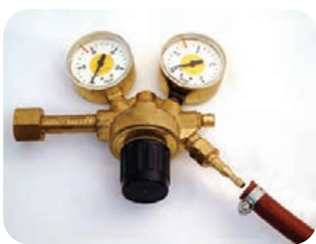
اتصال شیلنگ به رگولاتور گاز
