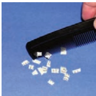
▶ شکل ۲-۱۰۷ ایجاد الکتریسیته ساکن در اثر اصطکاک
