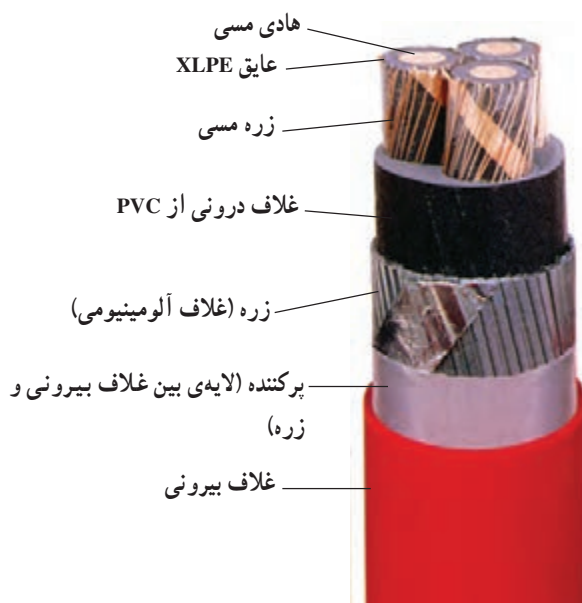
شکل ۵-۷ کابل با غلاف آلومینیومی
