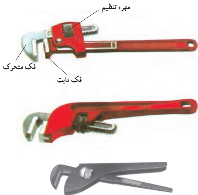
شکل ۸-۴ - چند نمونه آچار لوله‌گیر
