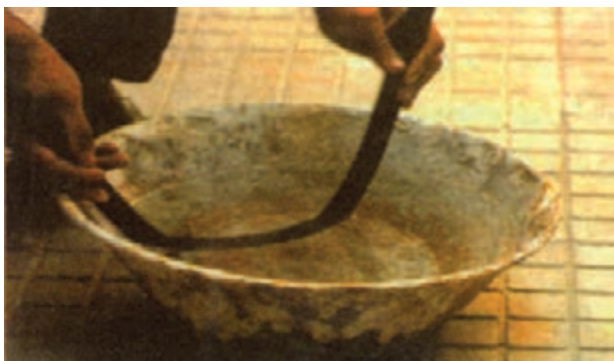
شکل ۴-۴۵ سرد کردن لوله پس از خم کاری
