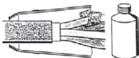
ب - خشن‌کاری سطح عایق هادی‌ها
