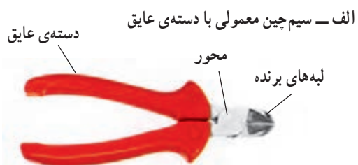
شکل ۱-۴ - دو نمونه سیم چین
