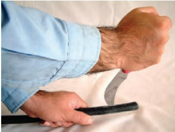
شکل ۵-۳۳- طریقه‌ی صحیح روکش برداری کابل
