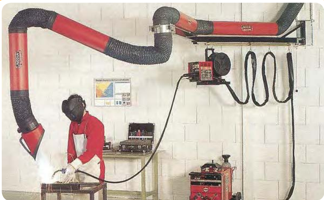
سیستم تهویه قابل انعطاف، دودهای متصاعد شده را مکش کرده و مانع از رسیدن آن به صورت جوشکار می‌شود.
