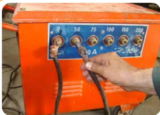
تنظیم آمپر در دستگاه ترانسفورماتور پله‌ای
