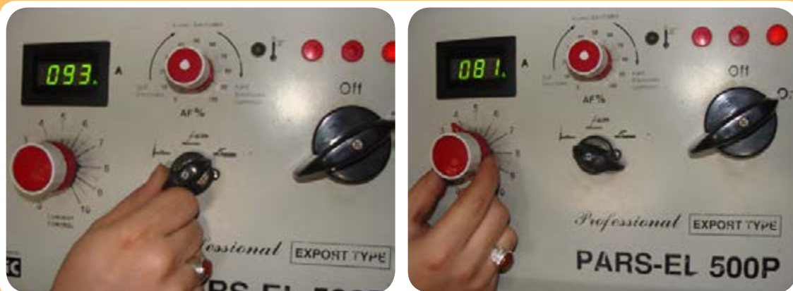
کلیدهای مختلف برای تنظیم دستگاه جوشکاری
