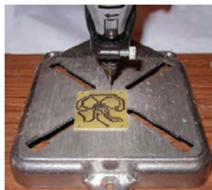
شکل ۸-۷ سوراخ کاری با دریل برقی
