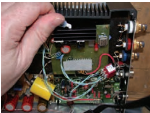
شکل ۷-۱۴ محل نصب هیت سینک
