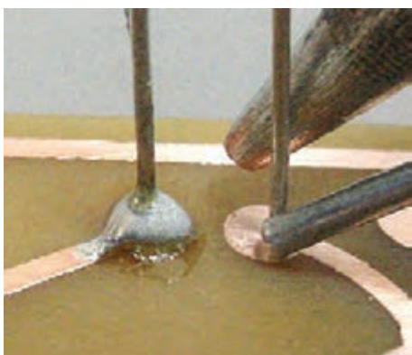
شکل ۱۰-۷ مونتاژ قطعات روی فیبر
