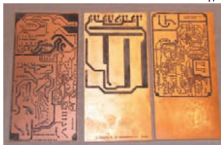
شکل ۶-۷ انتقال مدار چاپی روی فیبر
