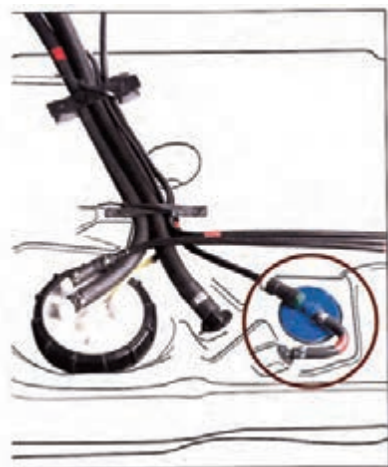
شکل (۱۶-۲) اتصالات سیستم سوخت رسانی
