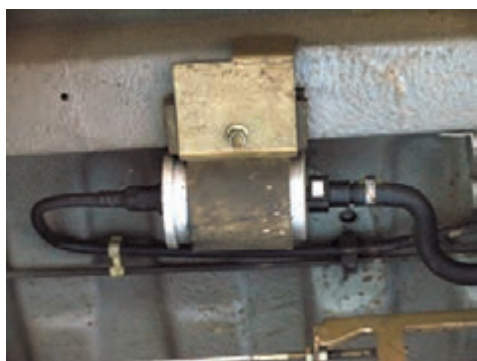
شکل (۲-۶۷) بست های دوطرف فیلتر سوخت
