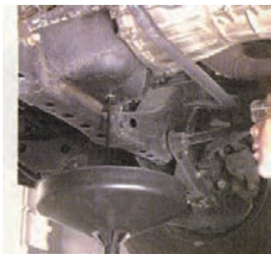
شکل (۲-۵۲) تخلیه روغن در ظرف مناسب
