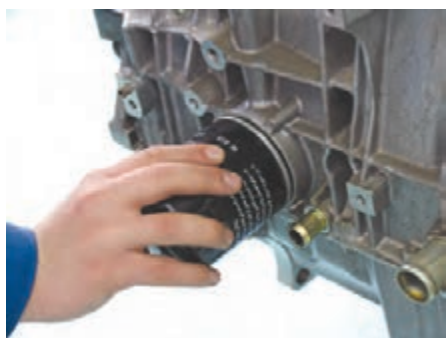
شکل (۲-۵۴) نصب و محکم کردن فیلتر
