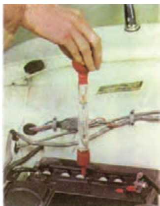
شکل (۲-۸۸) اندازه گیری غلظت مایع باتری
