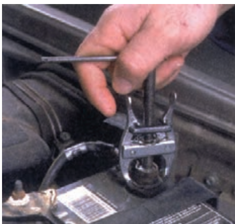
شکل (۲-۸۲) باز کردن بست باتری
