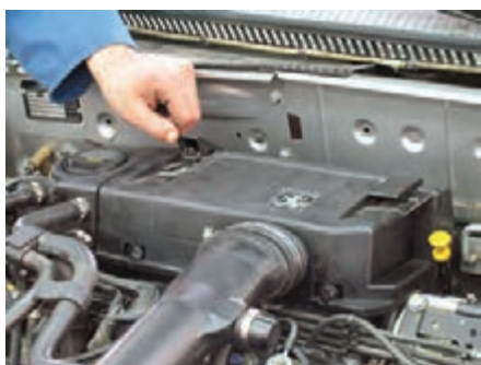
شکل (۲-۶۳) بازکردن در هواکش
