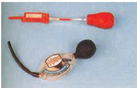
شکل (۲-۷۸) هیدرومتر اسیدسنگ
