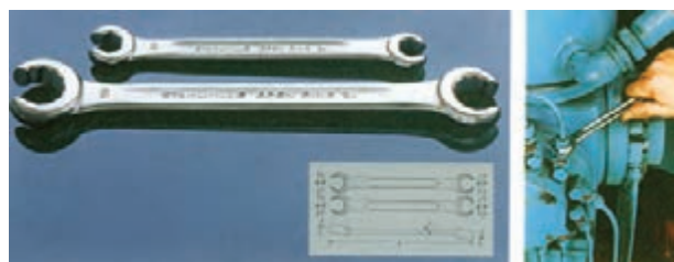
شکل (۱-۱۵) دو نوع آچار رینگی خاص
