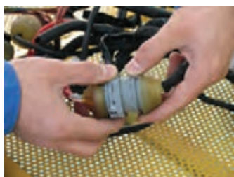
شکل ۳-۷۱ کانکتور پیچی
