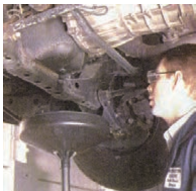
شکل (۲-۵۵) کنترل تخلیه شدن کامل روغن
