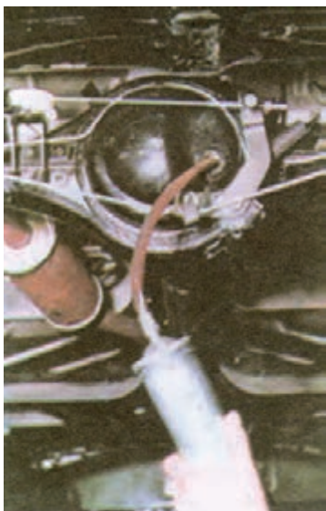
شکل (۲-۷۶) شارژ روغن دیفرانسیل
