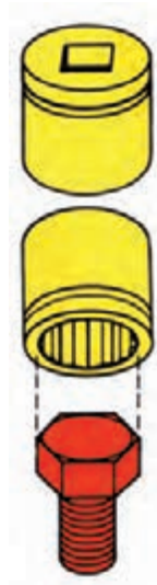
شکل (۱-۱۷) نحوه درگیری آچار بوکس
