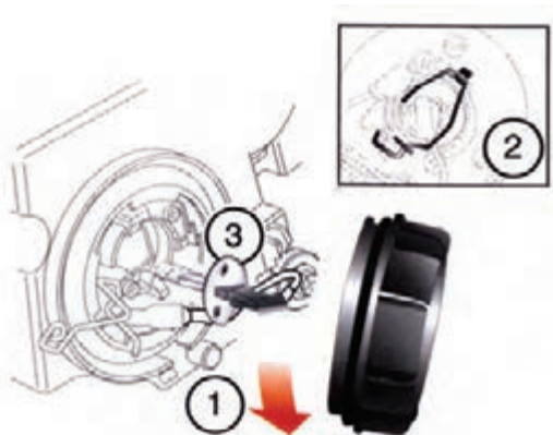
شکل (۲-۹۴) تعویض لامپ چراغ جلو نور بالا
