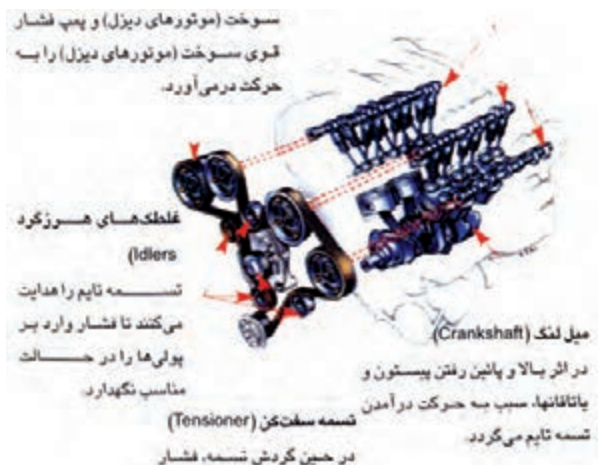
شکل (۱۳-۲ الف) تسمه تایمینگ موتور
