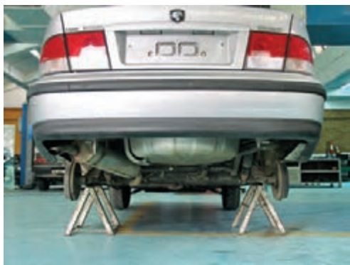
شکل (۱-۵۷) بالابر خودروی پایه‌ی ثابت
