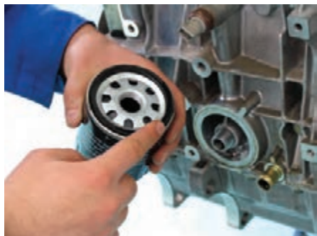
شکل (۲-۵۳) کنترل دندانه و واشر لاستیکی فیلتر
