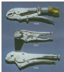
شکل (۱-۲۴) انواع انبر قفلی
