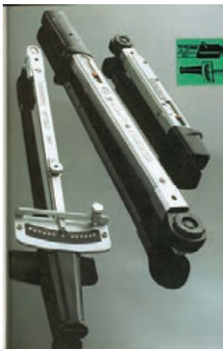
شکل (۱-۳۳) انواع آچار درجه‌دار
