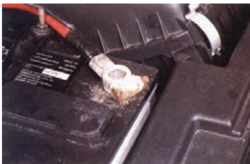
شکل (۲-۸۱) سولفاته شدن بست باتری
