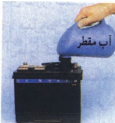
شکل (۲-۸۹) اضافه کردن مایع باتری
