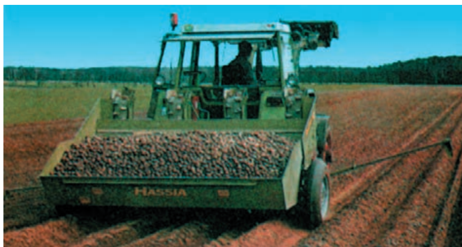
شکل ۲-۷- یک غده کار خودکار در حین کاشت سیب زمینی
