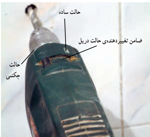
شکل ۲۱۲-۳ سوراخ کردن محل علامت‌گذاری شده
