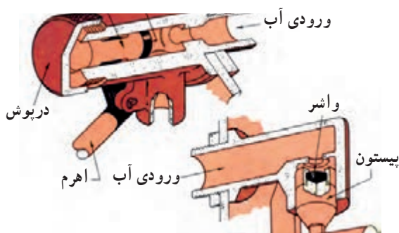
شکل ۱۱۳-۲ - اجزای شیر شناور
