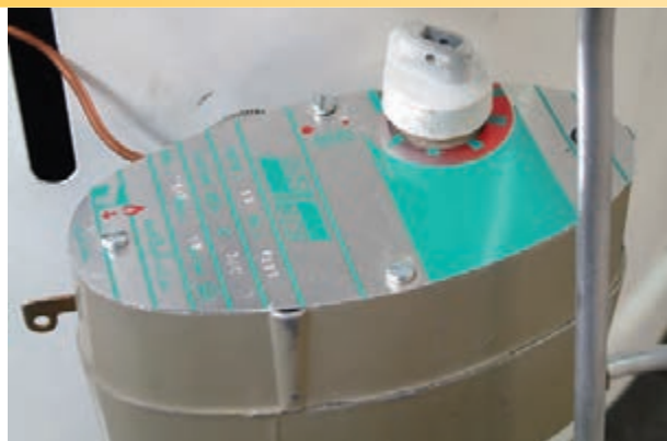
شکل ۵۲-۱- قرار دادن کلید گردان در حالت خاموش
