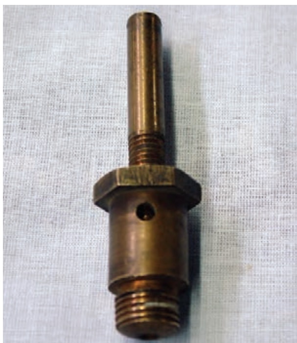
شکل ۱-۳۲- شیر قطع و وصل مخزن سوخت
