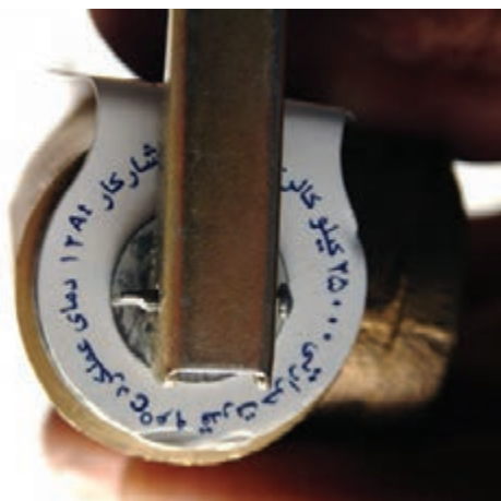
شکل ۲-۱۰۸- شیر اطمینان فشاری و حرارتی
