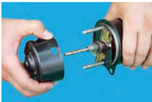
شکل ۴۵-۴ جدا کردن پوسته‌ی موتور
