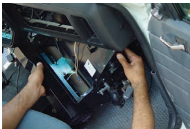
شکل ۴-۳۴- خارج کردن بخاری از محل نصب آب
