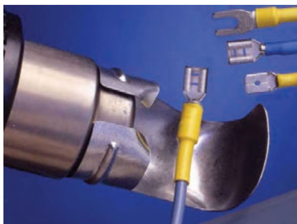
شکل ۶-۳۱ عایق‌کاری محل اتصال سیم و سرسیم
