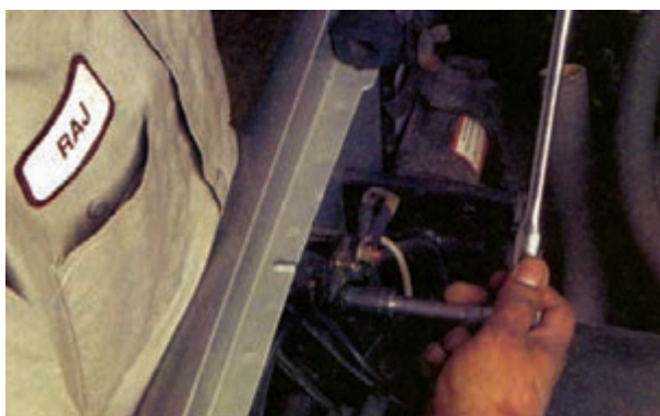
شکل ۸-۴۵ - اندازه‌گیری افت ولتاژ رله‌ی استارتر
