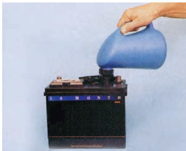
شکل ۲۷-۱- پر کردن خانه‌های باتری نو با الکترولیت
