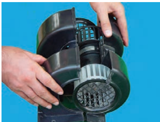
شکل ۴-۴۰ – جدا کردن محفظه‌ی نگه‌دارنده‌ی موتور
