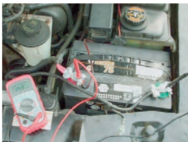
شکل ۷-۱۰۲- اندازه‌گیری ولتاژ شارژ
