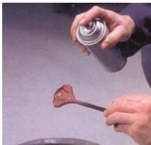
شکل ۹۳-۱- اسپری ضدخوردگی روی بست نگه‌دارنده‌ی باتری
