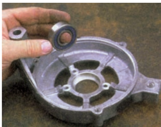
شکل ۷۰-۷ - خارج کردن بلبرینگ و آزمایش آن
