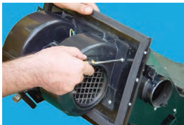
شکل ۴-۳۶- باز کردن پیچ‌های محفظه‌ی موتور
