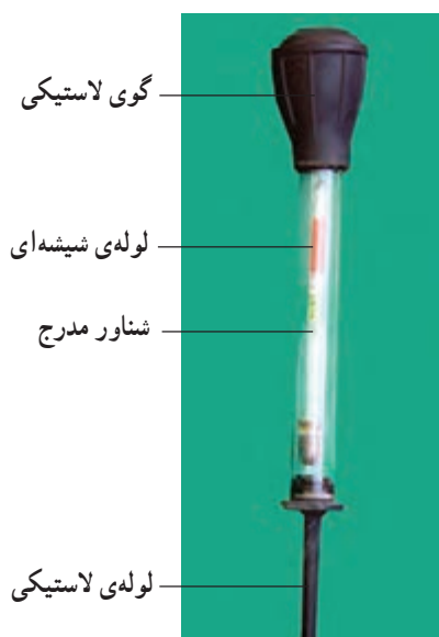
شکل ۱-۱۴- دو نوع هیدرومتر یا چگالی سنج
