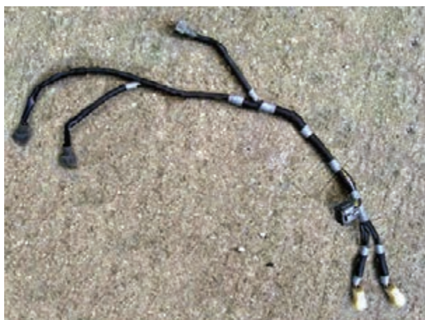
شکل ۳-۱۲- دسته سیم مدار شارژ
