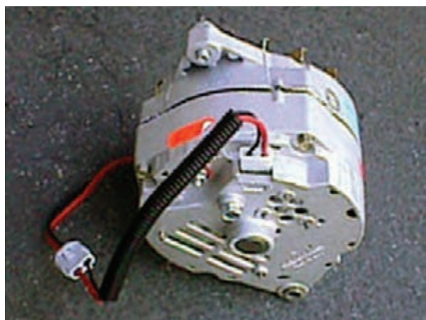
شکل ۳-۱۶- آلترناتور مجهز به آفتامات الکترونیکی
