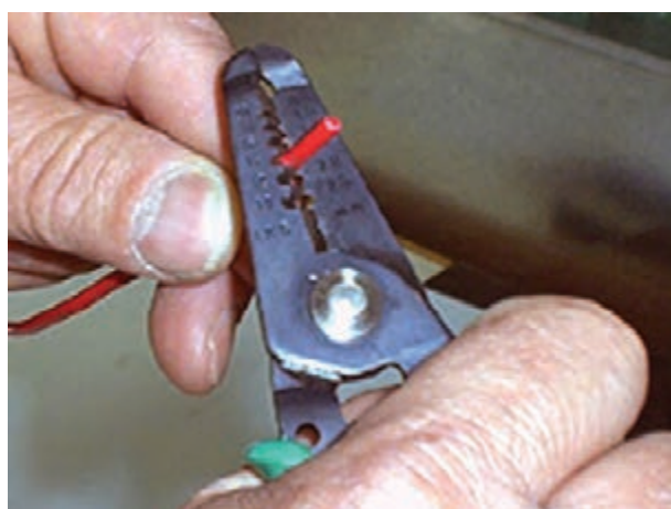
شکل ۳-۳۸- جدا کردن عایق سر سیم‌ها
