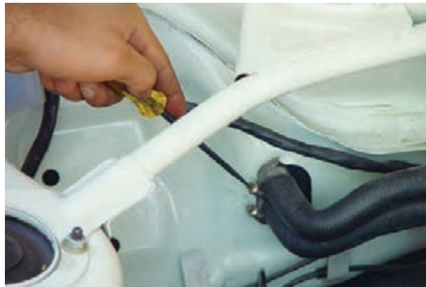
شکل ۴-۳۱- باز کردن لوله‌های آب رادیاتور بخاری
