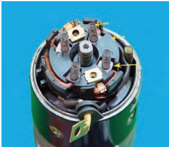
۱- فتر زغال ۲- پایه‌ی نگه‌دارنده‌ی زغال ۳- زغال شکل ۲۳- ۸- مجموعه‌ی زغال‌ها و نگه‌دارنده‌ی آن‌ها
