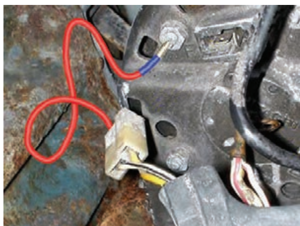
شکل ۳-۳۶ - آزمایش مدار لامپ شارژ
