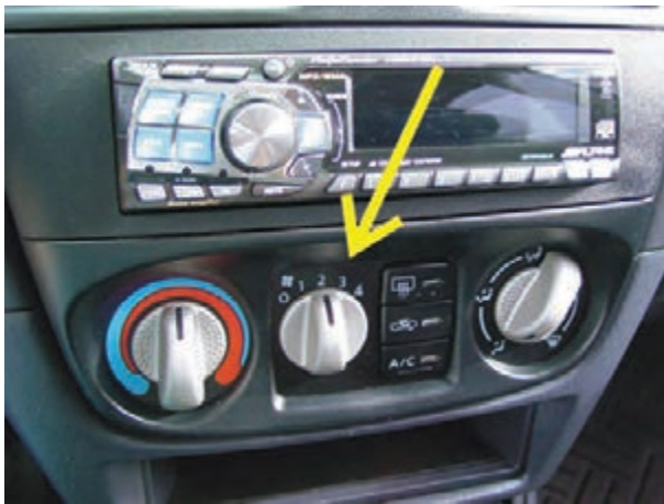
شکل ۴-۵۲- سوئیچ فن چهار وضعیتی
