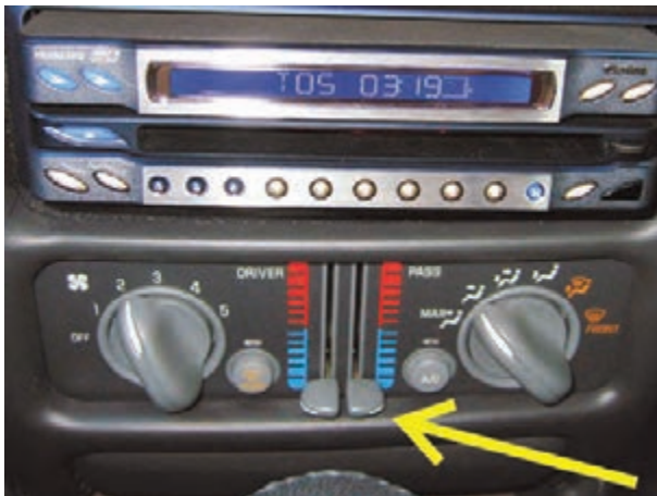
شکل ۴-۵۴- اهرم‌های تنظیم هوای ورودی
