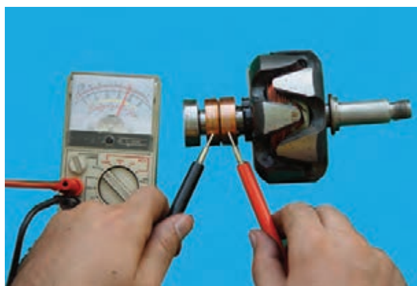
شکل ۷۵-۷ — آزمایش سالم بودن سیم پیچ روتور
