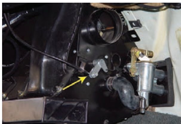
شکل ۴-۳۲- اتصالات دریچه‌ی بخاری
