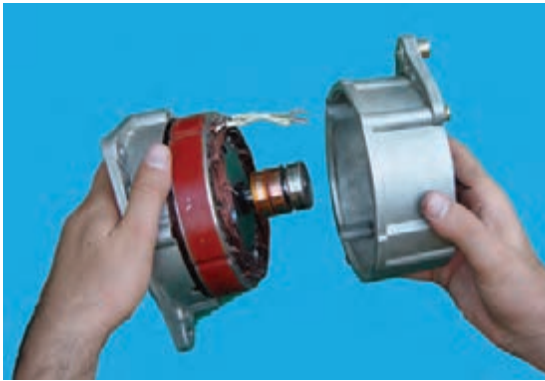
شکل ۶۱-۷ – جدا کردن درپوش‌های آلترناتور
