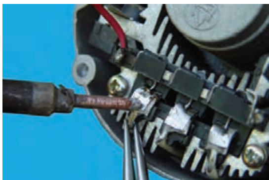
شکل ۷-۵۶- جدا کردن سیم‌های استاتور از یک‌سوکننده
