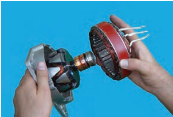
شکل ۶۲-۷ – جدا کردن استاتور
