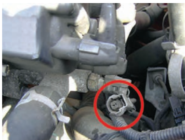
شکل ۱۶-۶ جدا کردن سوکت اتصال
