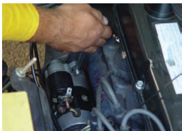
الف – باز کردن پیچ‌های استارتر
