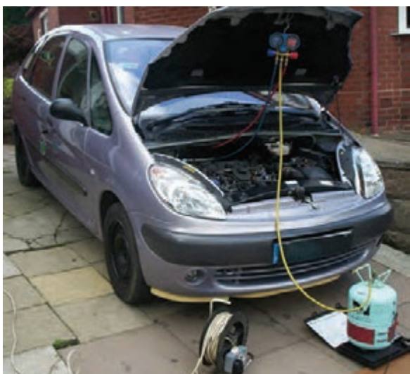
شکل ۳۵-۵ شارژ گاز کولر
