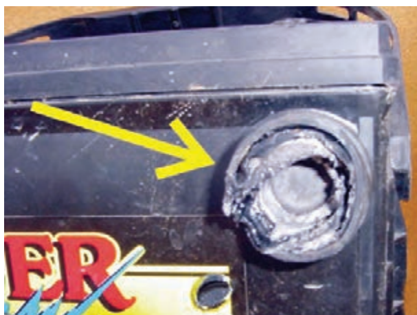
شکل ۳۶-۲- معیوب بودن ترمینال باتری
