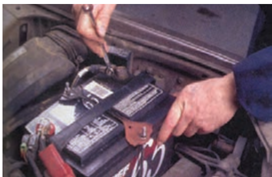
شکل ۱-۹۵- اتصال کابل‌های مثبت و منفی باتری
