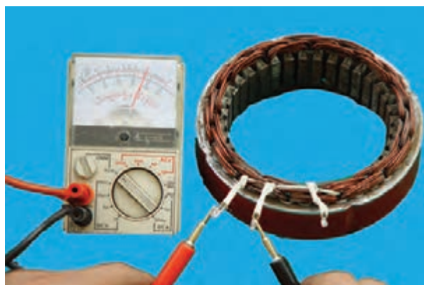
شکل ۷-۷۹ — آزمایش سالم بودن سیم پیچ استاتور
