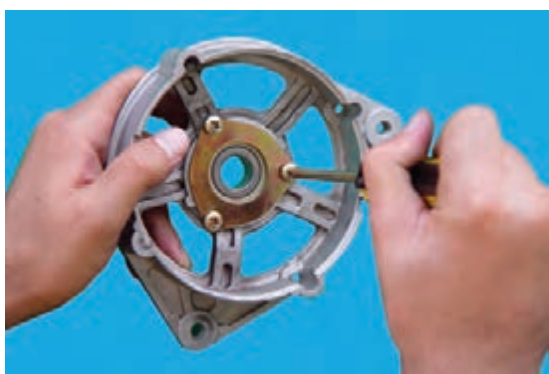
شکل ۶۷-۷ - باز کردن پیچ‌های نگه‌دارنده‌ی بلبرینگ
