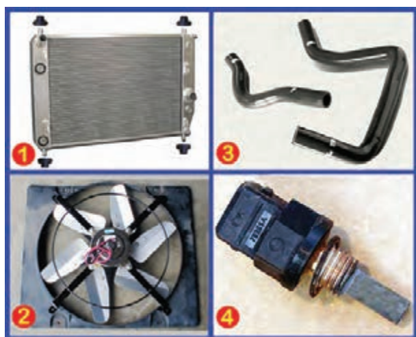
شکل ۲-۶- اجزای مدار خنک کاری
