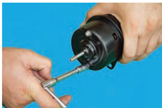
شکل ۴-۴۴- باز کردن پیچ‌های پوسته‌ی موتور
