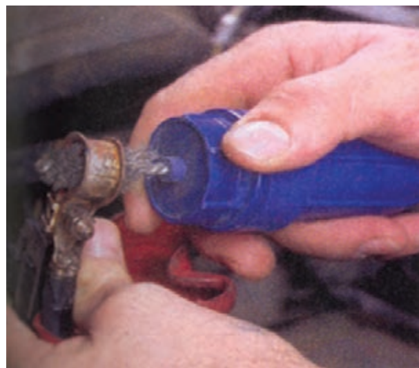
شکل ۹۱-۱ - پاک کردن بست‌های باتری با برس سیمی
