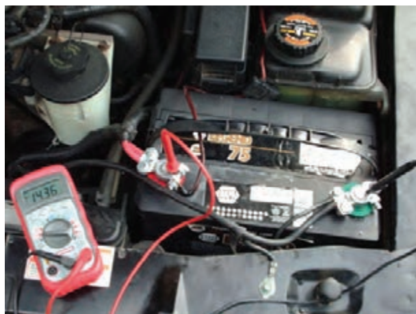
شکل ۱-۶۶ — اندازه گیری ولتاژ باتری
