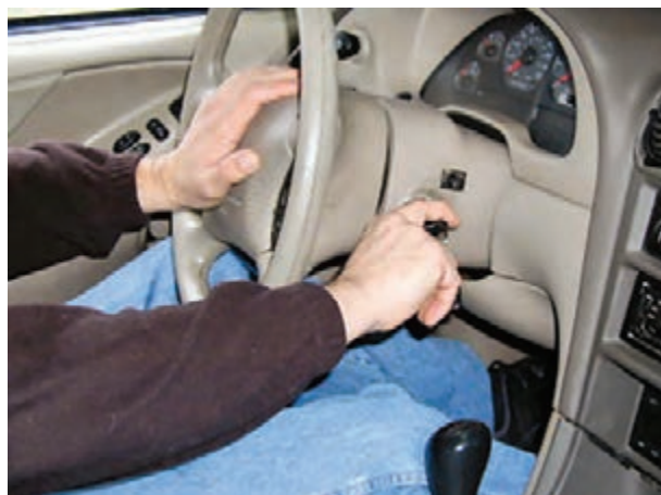
شکل ۴۵- ۷- روشن کردن موتور
