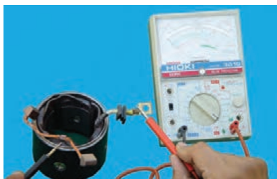
شکل ۸-۷۵ - آزمایش اتصال بدنه‌ی بالشتک
