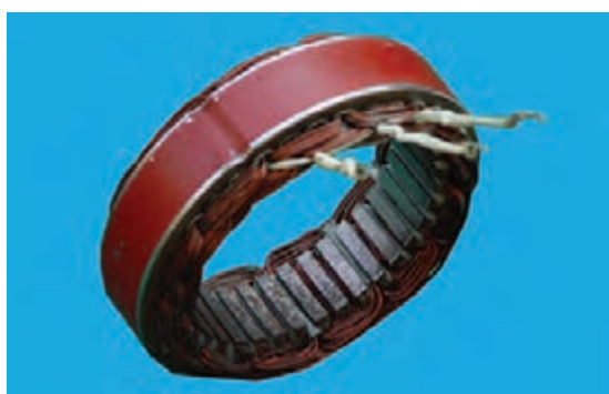
شکل ۷-۳۷- استاتور با سرپیچ های خروجی
