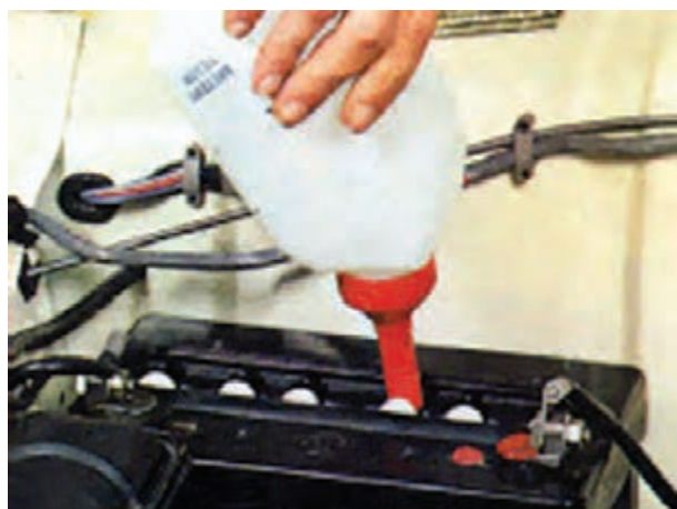
شکل ۱-۷۴- کنترل سطح الکترولیت
