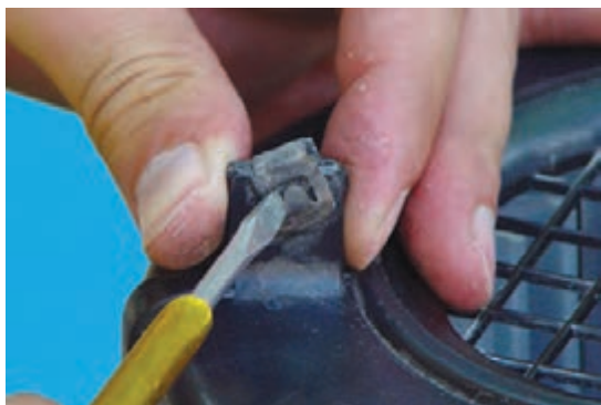
شکل ۴-۳۸ – باز کردن ضامن خار
