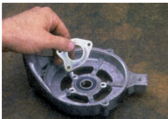
شکل ۶۸-۷ - در آوردن نگه‌دارنده‌ی بلبرینگ
