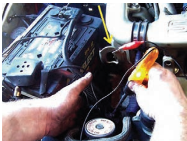
شکل ۴۳-۵ نحوه ی آزمایش سالم بودن سیم کشی
