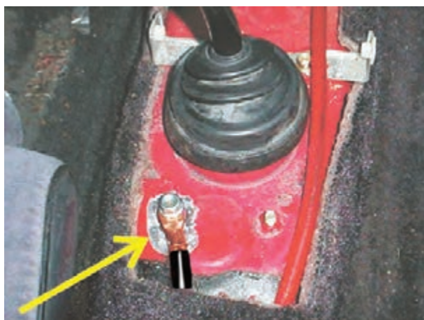
شکل ۲-۲۵- اتصال بدنه‌ی باتری در داخل اتاق خودرو
