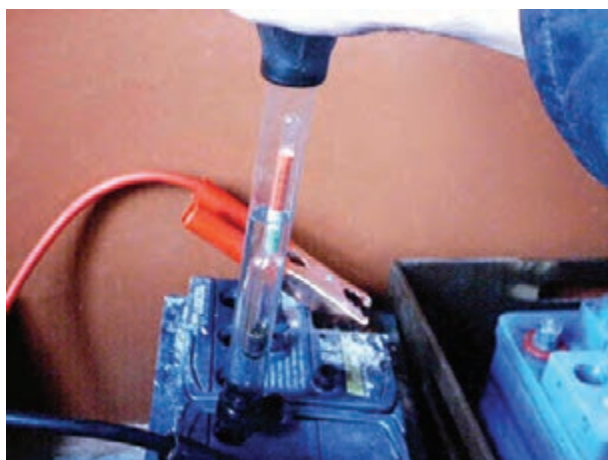
شکل ۱-۵۳- کنترل غلظت الکترولیت
