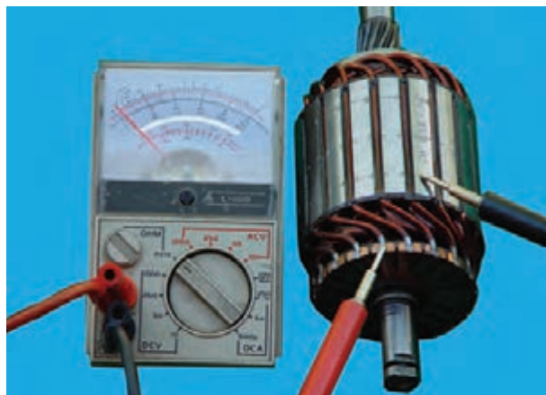
شکل ۸-۶۷ — آزمایش اتصال کوتاه شدن آرمیچر
