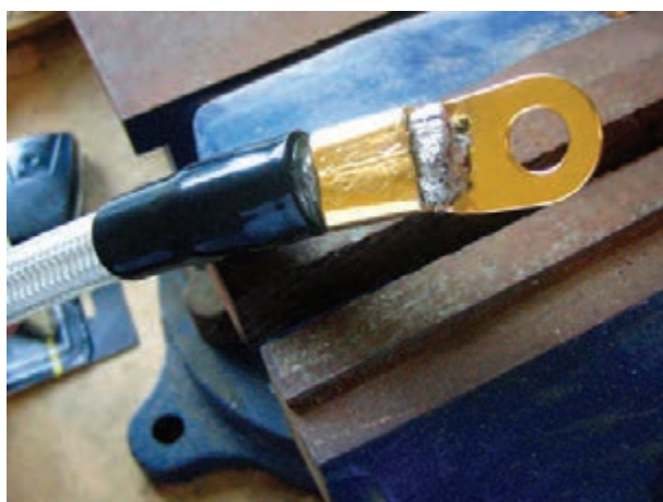
شکل ۳۱-۲ استفاده از گیره فلزکاری برای پرچ بست در روی کابل
