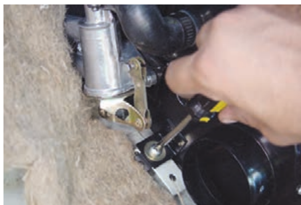
شکل ۴-۳۳- پیچ‌های پایه‌ی بخاری
