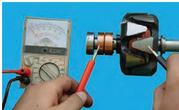
شکل ۷۴-۷ — آزمایش اتصال بدنه نبودن سیم پیچ روتور
