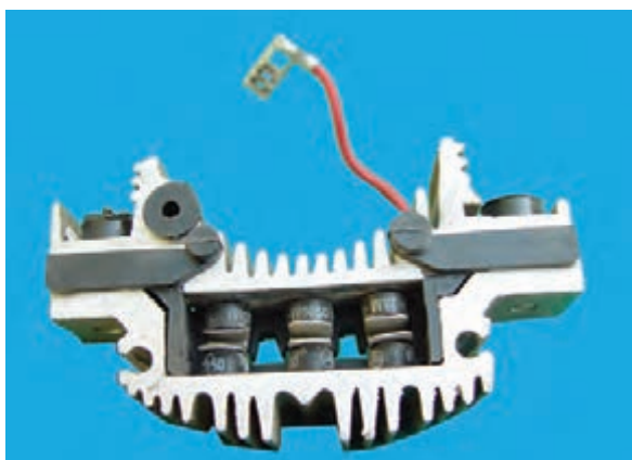
شکل ۷-۴۲ - مجموعه‌ی یک‌سوکننده
