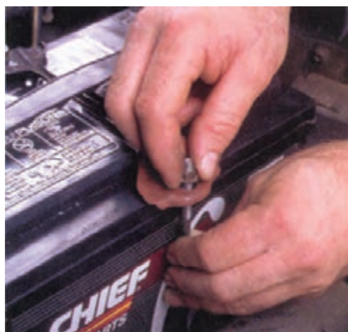
شکل ۹۴-۱- بستن باتری روی خودرو
