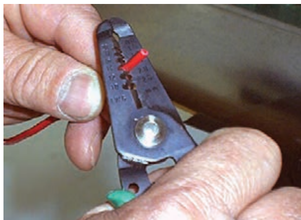
شکل ۶-۳۰ جدا کردن عایق سیم
