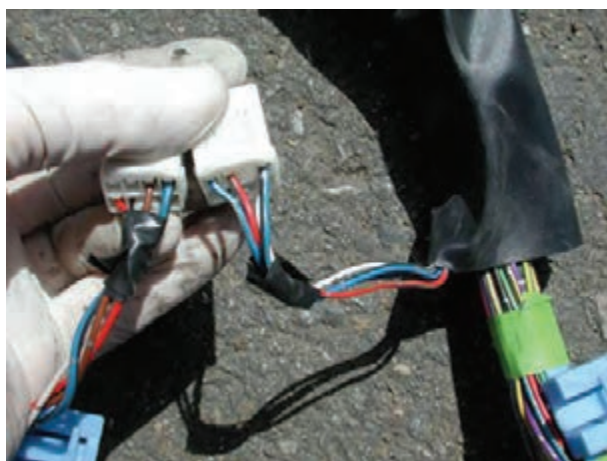
شکل ۳-۲۳- مقایسه و تطبیق سوکت‌های کلاف سیم‌کشی
