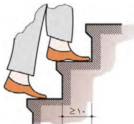
شکل ۱۶-۳ کوچک‌ترین اندازه‌ی کف پله در پله‌های پیچ
