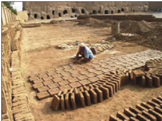
شکل ۱-۵۴ خشت خام (ساخت آجر به روش دستی)
