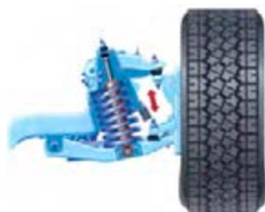
شکل ۲-۱۴ فنرهای به کار رفته در چرخ‌های خودرو
