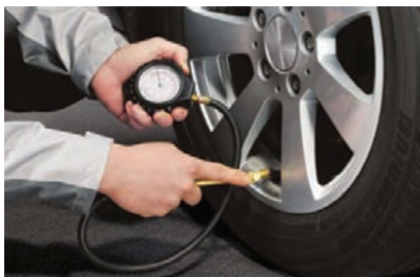
شکل ۱۰- اندازه‌گیری و تنظیم فشار باد تایر
