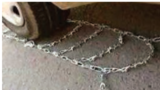
شکل ۱۳- بستن زنجیر چرخ
