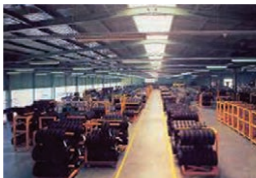
شکل ۱۱- انبار کردن صحیح تایر
