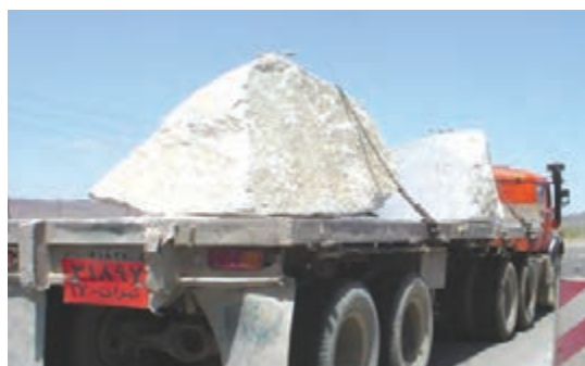
شکل ۱۷- نمونه‌ای از مهار نادرست سنگ‌ها
