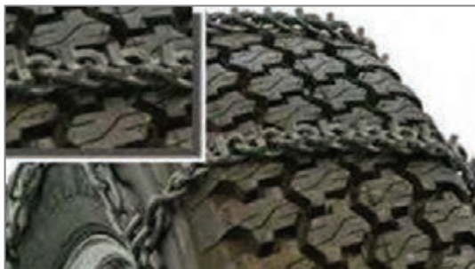
شکل ۱۳- بستن زنجیر چرخ
