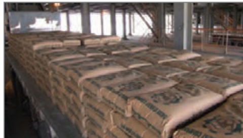
شکل ۱۲- نحوه چیدن کیسه‌ها روی یکدیگر
