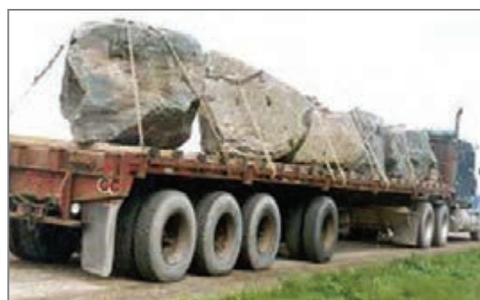
شکل ۱۶- نمونه‌ای از مهار صحیح سنگ‌ها
