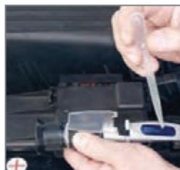
شکل ۱۰- اندازه گیری الکترولیت باتری
