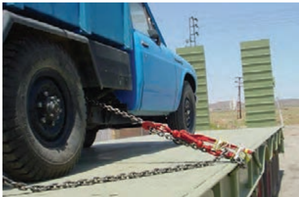
شکل ۲۲- نمونه‌ای از مهار نادرست یک اتومبیل
