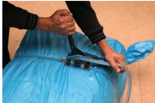
شکل ۸۵- کشیدن نوار به کمک ابزار نوارکش
