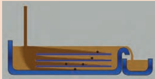
شکل ۲۰- نحوه قرار دادن صفحات موازی درون فیلتر
