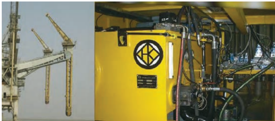
شکل ۲۱- سامانه هیدرولیک تخلیه غلات بندر امام خمینی (ره) که توسط یک شرکت داخلی نوسازی گردیده است
