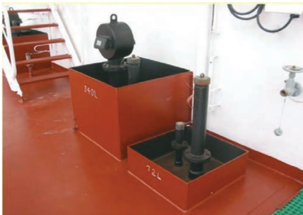
شکل ۲۵- سامانه هوا و اندازه‌گیری مخزن یک کشتی
