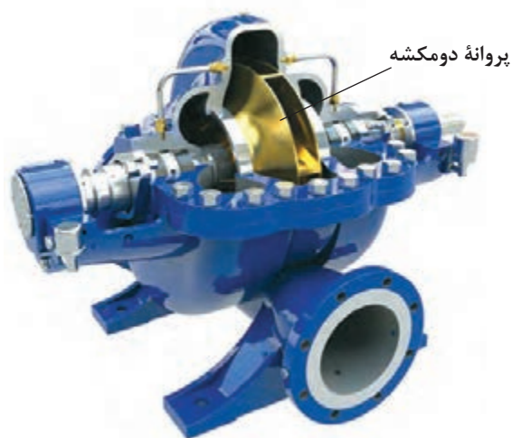
شکل ۴۱ - پمپ‌های دو مکشه برای افزایش دبی خروجی
