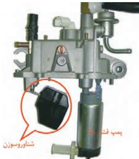
شکل ۸- مجموعه داخل مخزن تفکیک بخار
