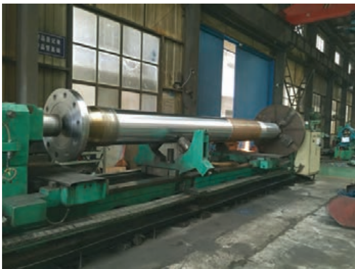
شکل ۱۰- محور پروانه در کارگاه جهت ماشین‌کاری
