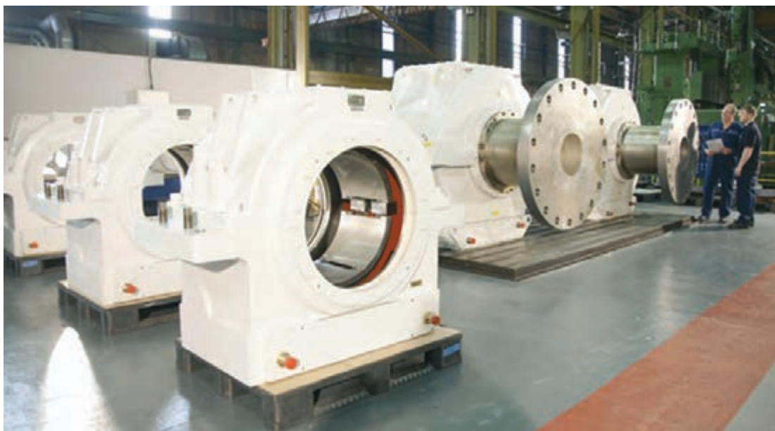
شکل ۲۴- یاتاقان‌های مورد استفاده جهت تکیه‌گاه محور پروانه
