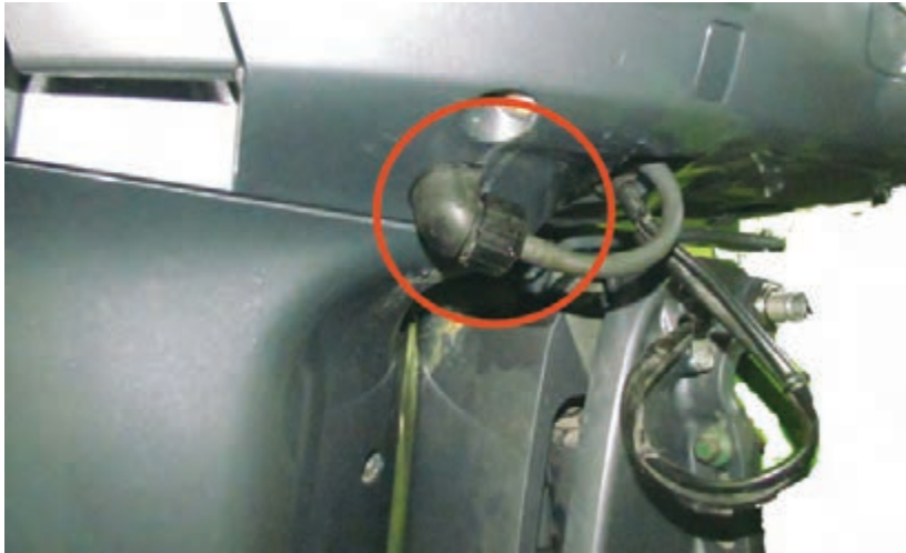
شکل ۳۴- محل ورودی آب شیرین به مسیر شستشوی موتور
