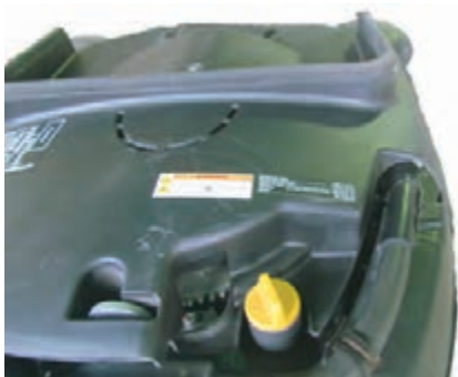
شکل ۲۸- برچسب نوع و مقدار روغن همچنین محل شارژ آن
