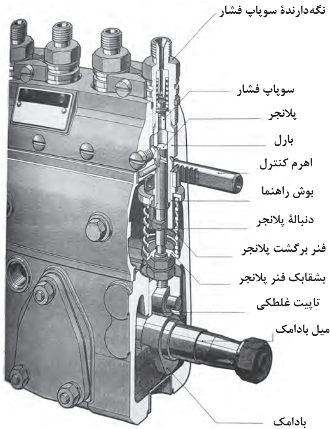
شکل ۳۱- پمپ انژکتور نوع جرک
