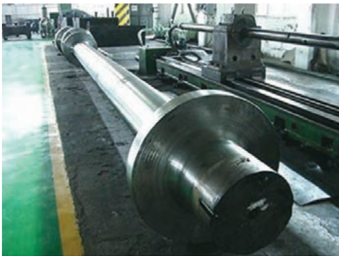
شکل ۹- یک نمونه محور پروانه مورد استفاده در شناورهای بزرگ
