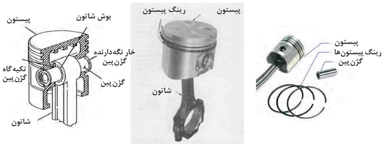
شکل ۲- پیستون و قطعات همراه آن
