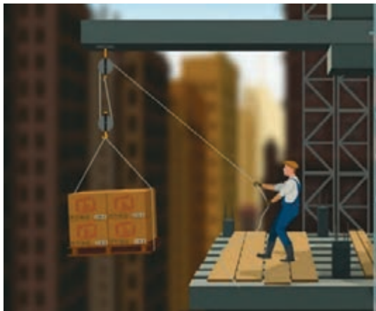
شکل ۲۶- ترکیب دو قرقه برای افزایش بهره مکانیکی
