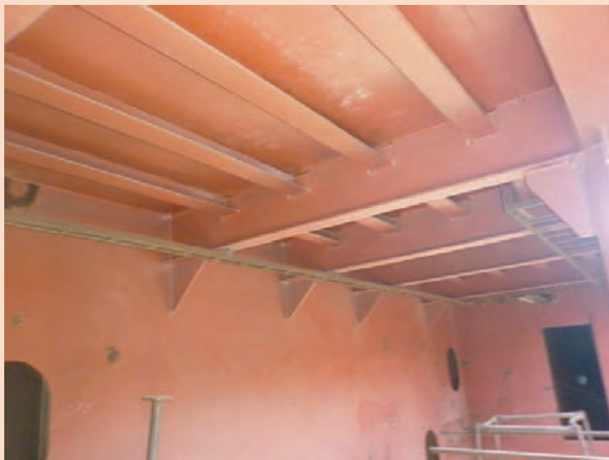
شکل ۱۷- تیرهای سقفی عرضی یک کشتی در حال ساخت
