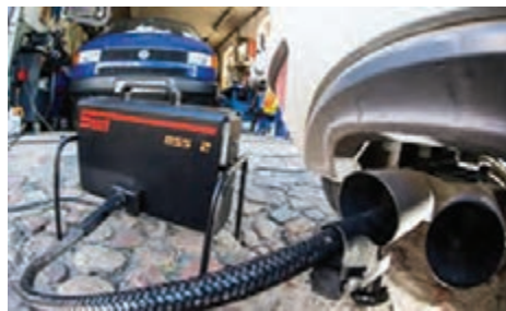
شکل ۵۴- قراردادن لوله دستگاه کنترل آلاینده‌گی درون لوله‌اگزوز
