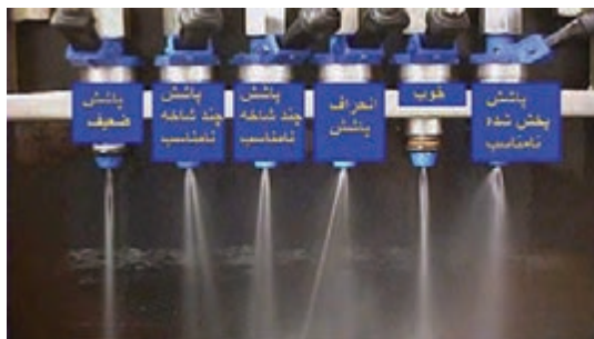
شکل ۷۷- انواع احتمالی پاشش سوخت در انژکتور
