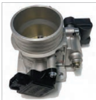
شکل ۲۹- مجموعه کامل دریچه گاز
