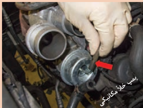
شکل ۲۷- پمپ خلأ مکانیکی
