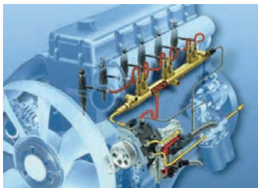
شکل ۷- موقعیت اجزای سیستم تزریق ریل مشترک روی موتور
