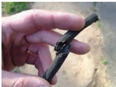
شکل ۴۹- یک نوع نشستی سیستم سوخت‌رسانی
