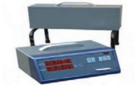
شکل ۳۳- یک نمونه دستگاه کدرسنجی دود
