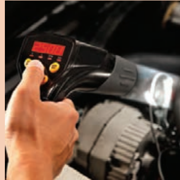
شکل ۲۱- روش کاربری چراغ تایمینگ
