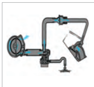
پمپ تزریق ثانویه اسماگ
