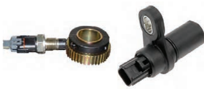
شکل ۵۸- حسگر و چرخ دنده بسته شده روی دیفرانسیل
