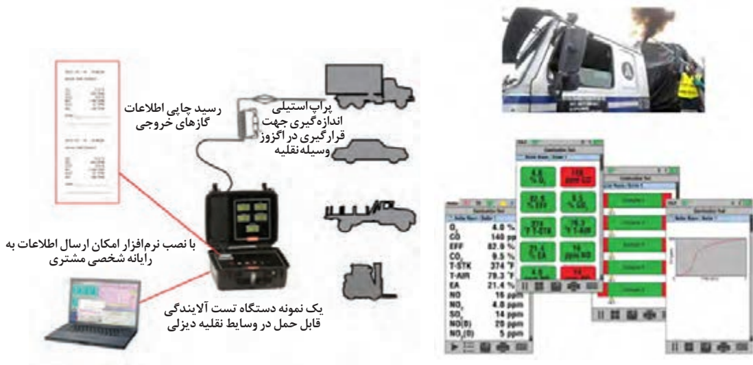
شکل ۳۲- یک نمونه دستگاه تست آلاینده‌ها در وسایط نقلیه دیزلی
