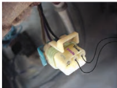
شکل ۳۵- آزمایش مقاومت داخلی قطعه
