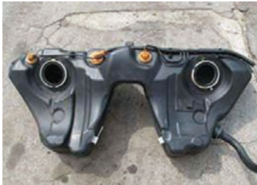
شکل ۷- مخزن سوخت با سوپاپ واژگونی
