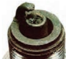
شکل ۳- آسیب به شمع بر اثر خودسوزی
