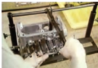
شکل ۵۷- برخی از مراحل باز کردن و بستن پمپ انژکتور ردیفی روی خودرو
