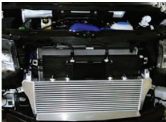
شکل ۳۴- اینتر کولرهای استفاده شده در خودرو
