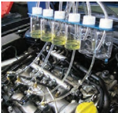
شکل ۴۰- تست اندازه گیری مقدار سوخت برگشتی انژکتورها
