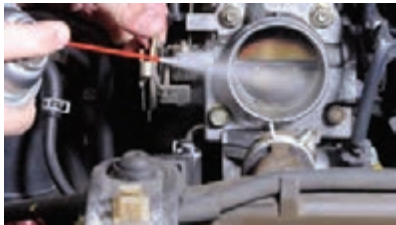
شکل ۸۱- سرویس دریچه گاز
