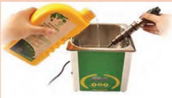
شکل ۸۳- تمیز کردن سوراخ انژکتور با دستگاه اولتراسونیک
