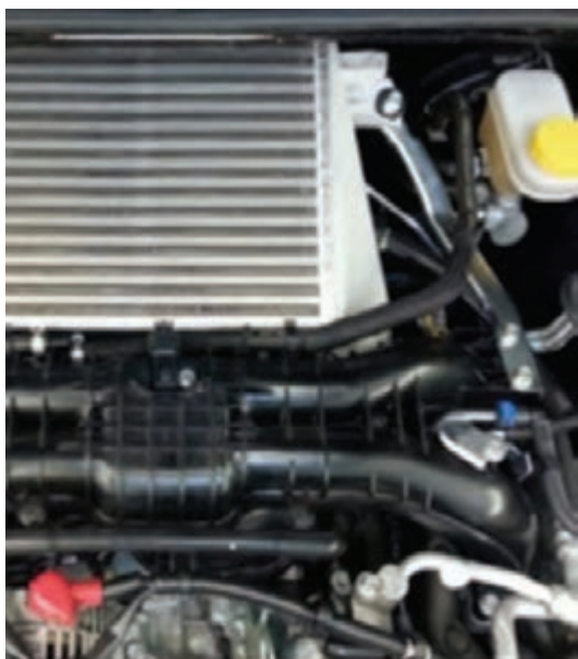
شکل ۳۵- افتر کولرهای استفاده شده در خودرو
