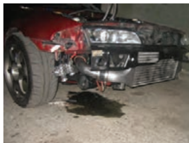
شکل ۴۹- یک نوع نشستی سیستم سوخت‌رسانی
