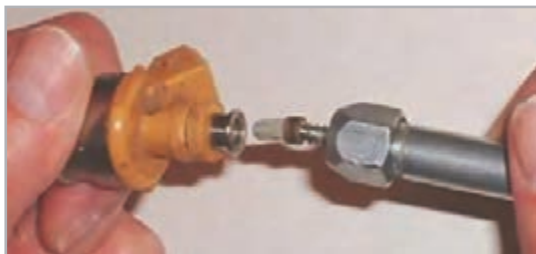
شکل ۷۹- تعویض فیلتر انژکتور
