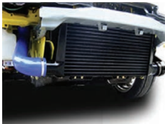
شکل ۳۴- اینتر کولرهای استفاده شده در خودرو
