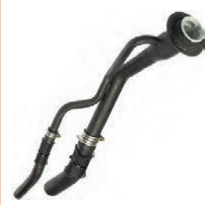
شکل ۳۷- لوله فلزی ورودی و مجرای کناری
