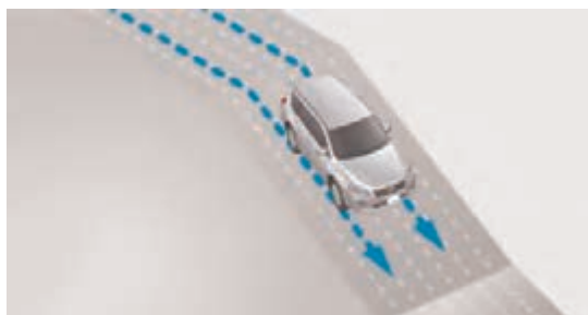
شکل ۲۷- سیستم DAC هنگام حرکت رو به پایین روی سطوح شیب‌دار و لغزنده، کنترل خودرو را بهبود می‌بخشد.
