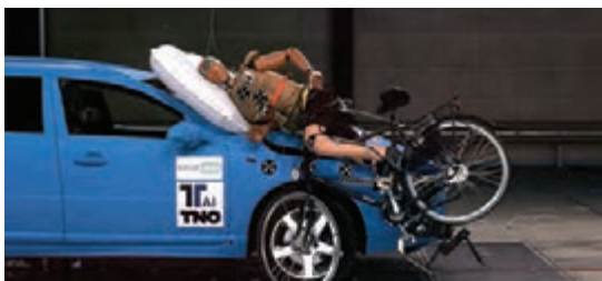
شکل ۶۲- خودروی مجهز به در موتور با کیسه هوا هنگام تصادف
