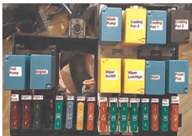
شکل ۲۰- جعبه فیوز یک خودرو
