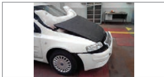
شکل ۶۱- در موتورهای ضربه‌گیر با کیسه هوا
