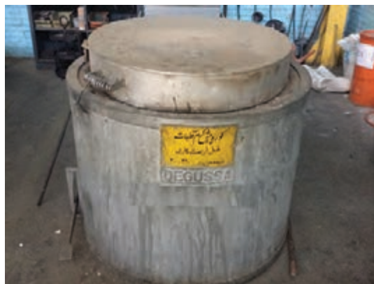
شکل ۱۹- کوره پیش گرم قطعات
