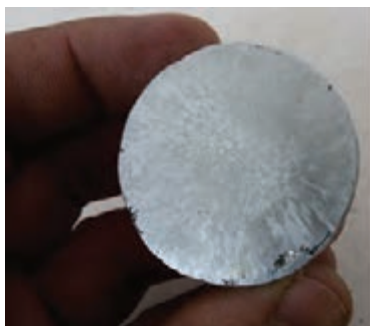
شکل ۱۰- نمونهٔ میکروسکوپی از فلز خالص آلومینیوم
