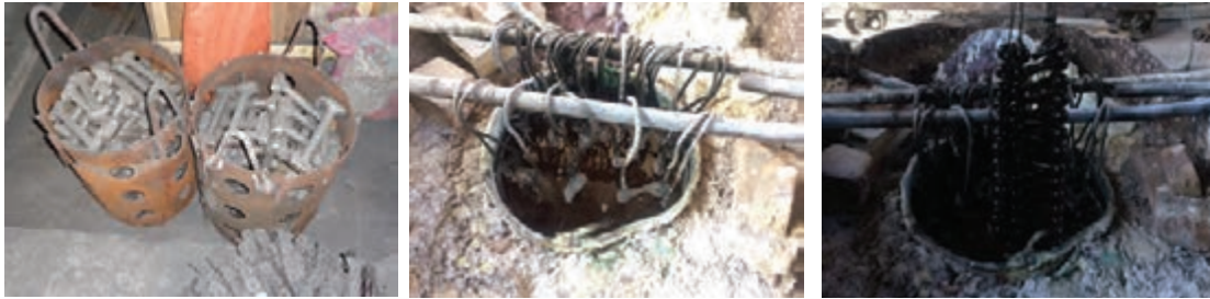
شکل ۲۶- تمپر کردن قطعات
