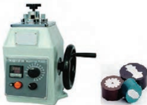
شکل ۱۳- دستگاه مانت گرم و نمونه‌های مانت شده
