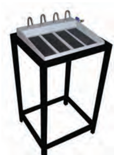
شکل ۱۲- صفحه‌های صاف سنبلاده کاری نمونه‌های متالوگرافی
