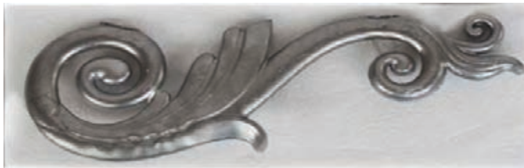
شکل ۵- گل نرده آلومینیومی تولید شده با ماشین ریخته‌گری تحت فشار
