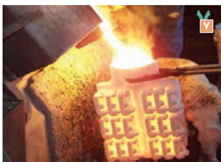
۱- ساخت مدل مومی ۲- مونتاژ کردن و ساخت خوشه ۳- فرو بردن خوشه در دوغاب سرامیکی ۴- بارش ماسه ۵- ساخت پوسته ۶- پیش گرم کردن خوشه و موم‌زدایی ۷- ذوب‌ریزی ۸- شکستن پوسته سرامیکی
