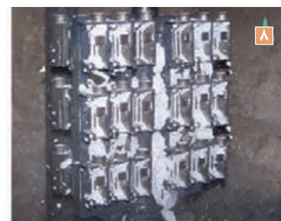
۱- ساخت مدل مومی ۲- مونتاژ کردن و ساخت خوشه ۳- فرو بردن خوشه در دوغاب سرامیکی ۴- بارش ماسه ۵- ساخت پوسته ۶- پیش گرم کردن خوشه و موم‌زدایی ۷- ذوب‌ریزی ۸- شکستن پوسته سرامیکی
