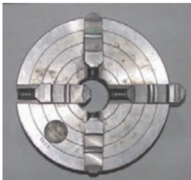
شکل ۱۸- سه‌نظام و چهارنظام تک‌رو
