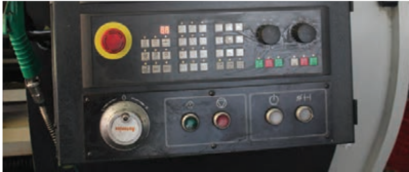
شکل ۱۶- قسمت اپراتوری سیستم کنترل
