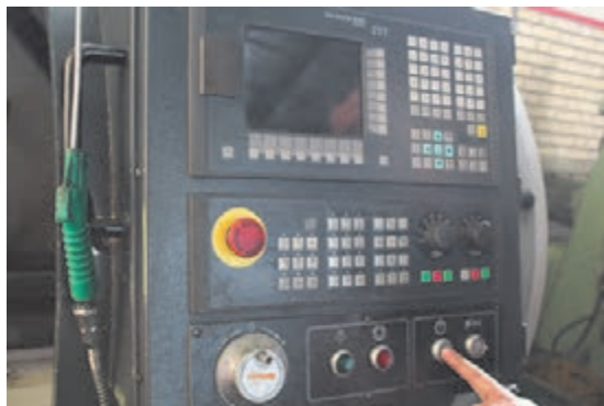
شکل ۱۹- روشن کردن سیستم هیدرولیک دستگاه
