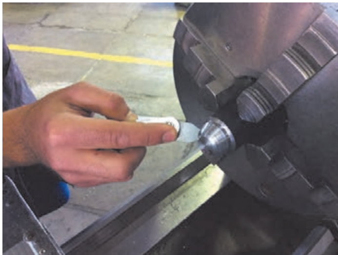
شکل ۱۲- کنترل فرم به وسیله شابلون
