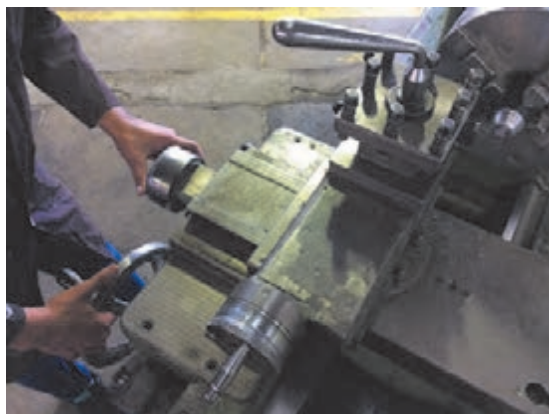
شکل ۱۰- حرکت همزمان سوپرت‌های دستگاه
