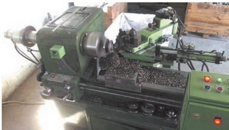
شکل ۷- عملیات کپی تراشی
