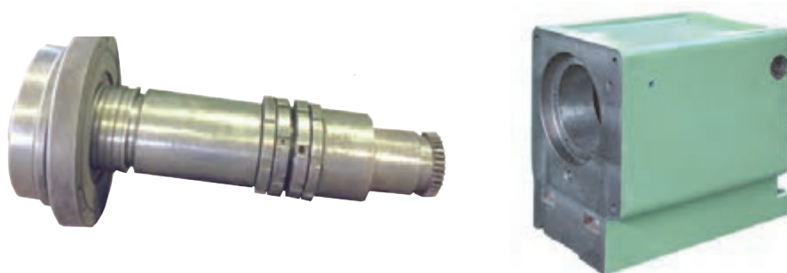
شکل ۱- پوسته و محور اصلی دستگاه تراش
