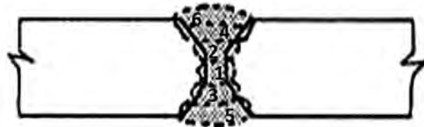
شیار V دو طرفه Double-V Groove (ب)
