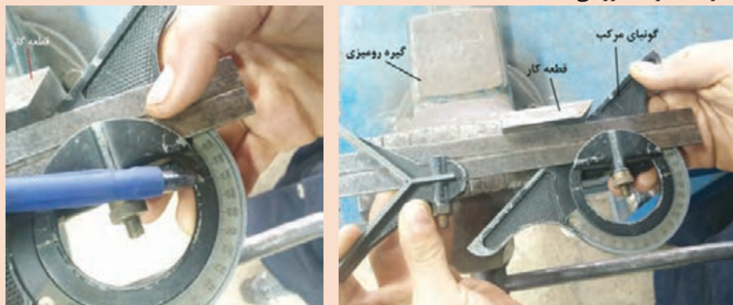
شکل ۲۳- بررسی صحت زاویه با گونیای مرکب
