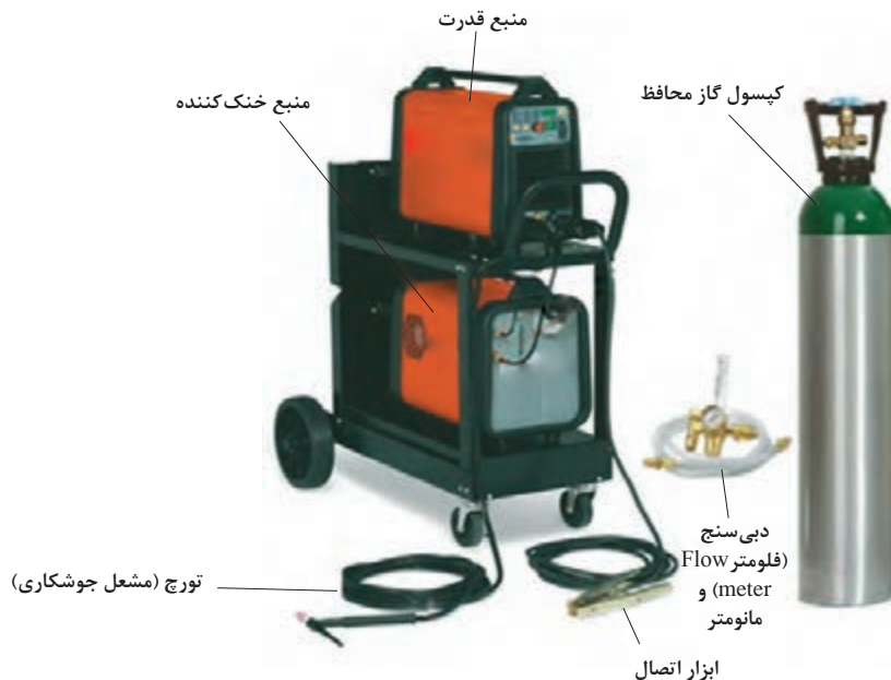
شکل ۲- تجهیزات فرایند GTAW
