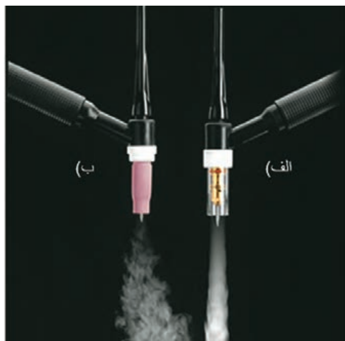
شکل ۱۴- لنز گازی در فرایند TIG
