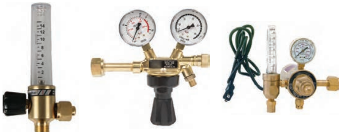
شکل ۱۷- انواع مانومتر و فلومتر
