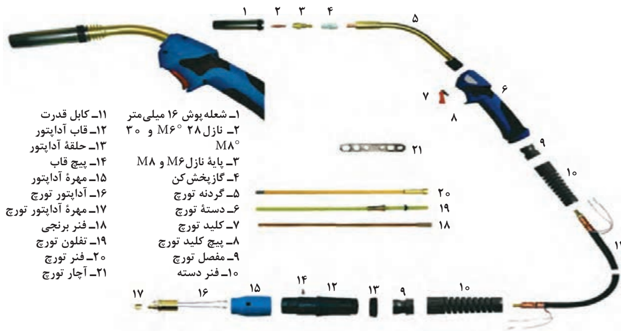
شکل ۷- اجزای تشکیل دهنده تورچ GMAW
