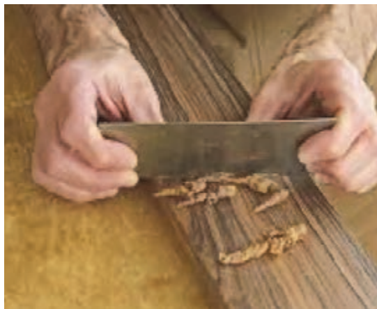
شکل ۵۵- لیسه کشی در جهت الیاف
