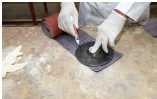
شکل ۲۹- ترسیم گردی دیسک روی سنباده
