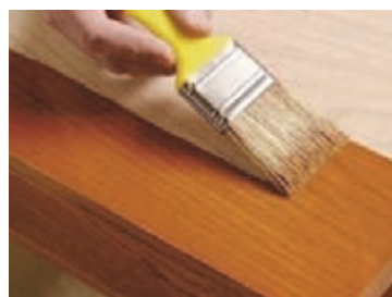
شکل ۵۷- روغن‌اندود کردن سطح کار
