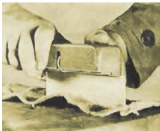
شکل ۶۲- مصقل کشی در لیسسه با رنده مصقل
