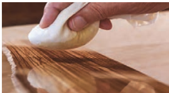
شکل ۲- استفاده از کهنه رنگ کاری برای نفوذ بهتر روغن بزرک
