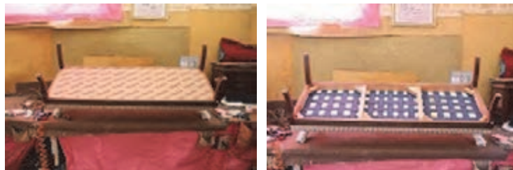
شکل ۳۹- پوشش کف مبلی با متقال
