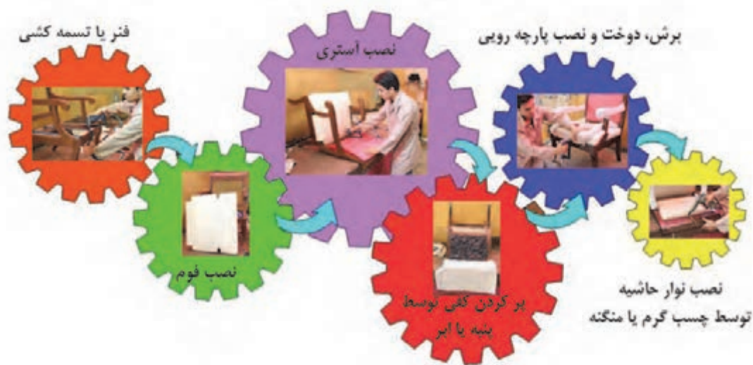
شکل ۲- مراحل اجرای رویه کوبی
