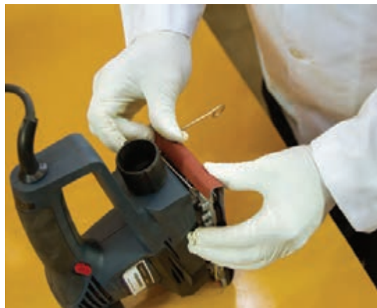
شکل ۴۴- روش جازدن سنباده
