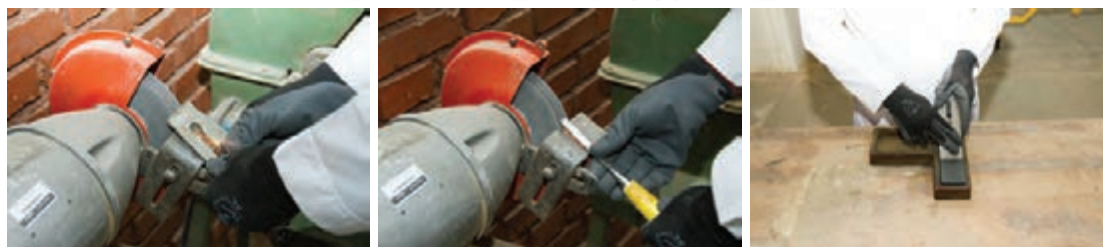
شکل ۳- تیز کردن تیغه رنده به صورت اصولی
