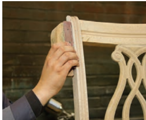
شکل ۹- سنباذه کاری به کمک تخته پوست
