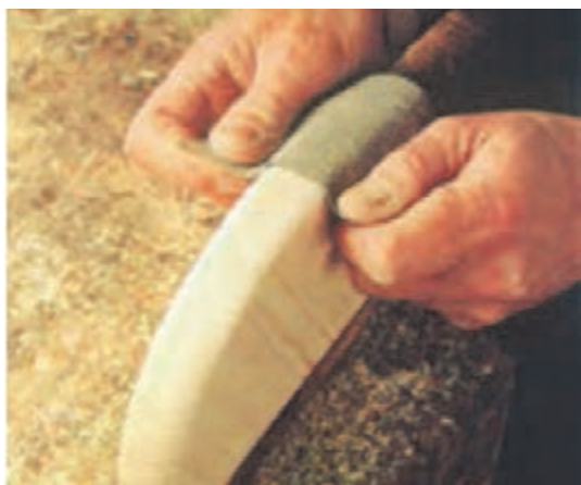
شکل ۱۵- سنباده کاری روی سطوح قوس دار
