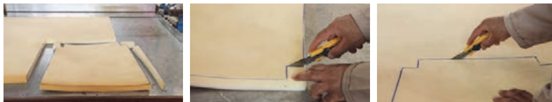
شکل ۴- برش کاری اسفنج کفی صندلی
