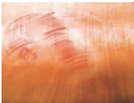
شکل ۲۶- اثر خط و خش روی سطح کار
