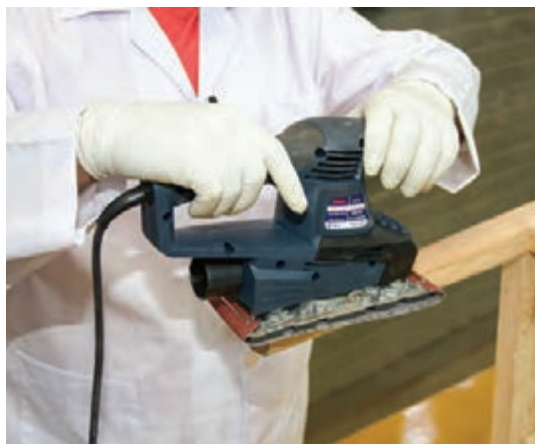
شکل ۴۶- سنباده کاری در جهت الیاف
