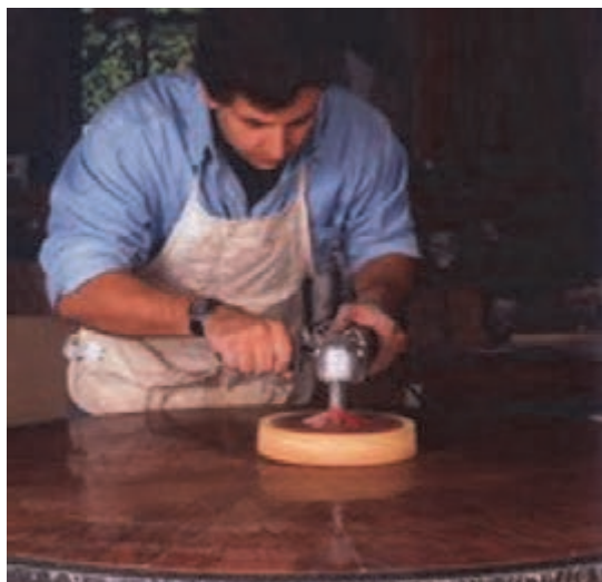
شکل ۴۷- پولیش کاری سطح پلی‌استر خورده
