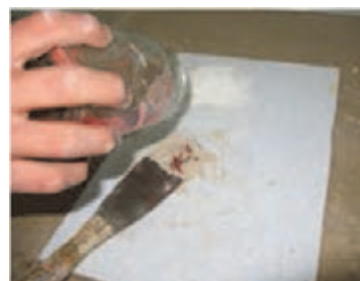
شکل ۵۰- اضافه کردن گل اخری به نمونه
