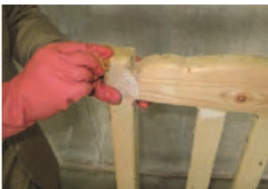
شکل ۷۱- بتونه کاری غیر پوششی
