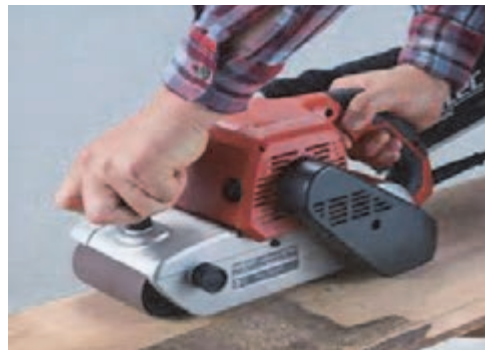
شکل ۴۸- سنباده کاری تخته‌های پهن
