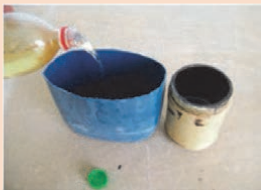
شکل ۸- اضافه کردن نفت به آستری قیری
