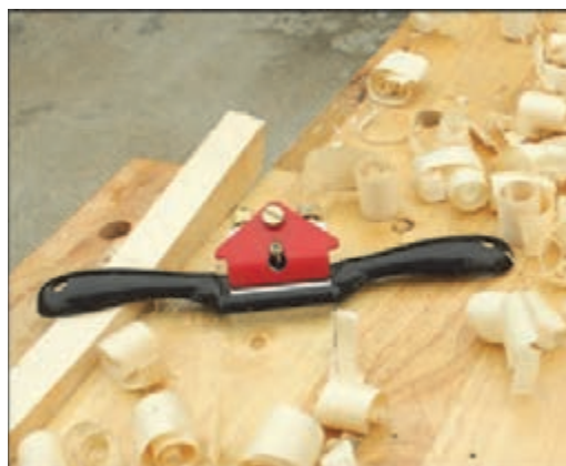
شکل ۵۸- نصب لیسسه به رنده بال کبوتری
