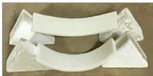
شکل ۳۰- آزمایش مقاومت پخت دو تکیه‌گاهی
