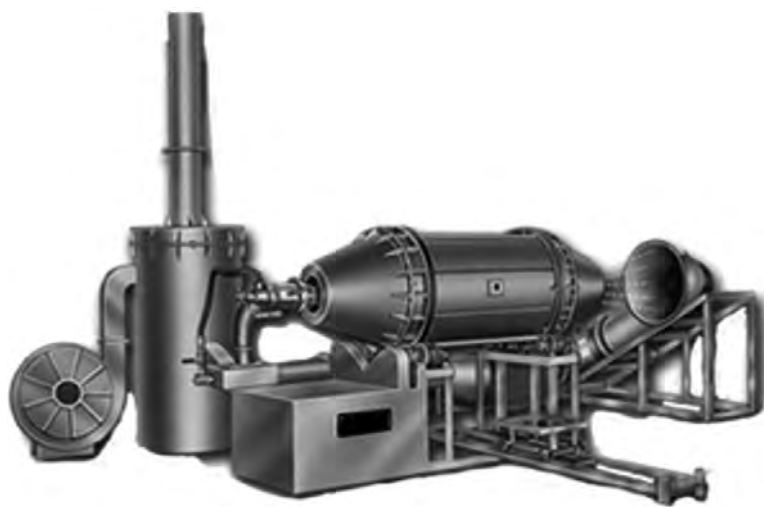
شکل ۲۰- مجموعهٔ کورهٔ دوار ناپیوسته
