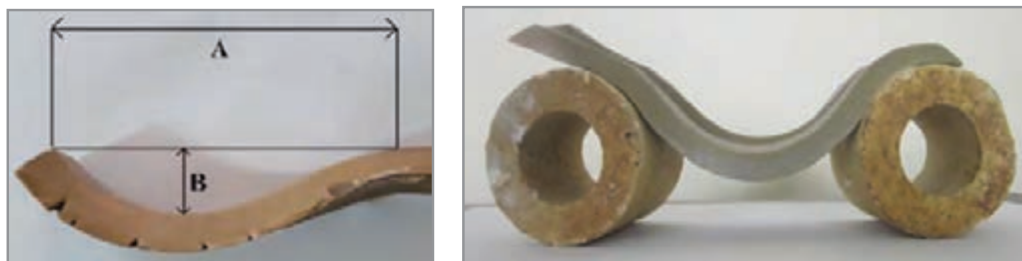
شکل ۳۶- اندازه‌گیری میزان انحنای نمونه مقاومت به پخت
