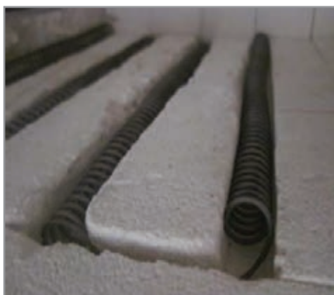
شکل ۱۳- نصب المنت درون شیار
