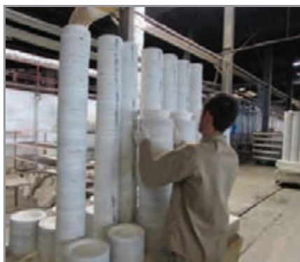
شکل ۴۹- استفاده از ساگار برای چیدمان
