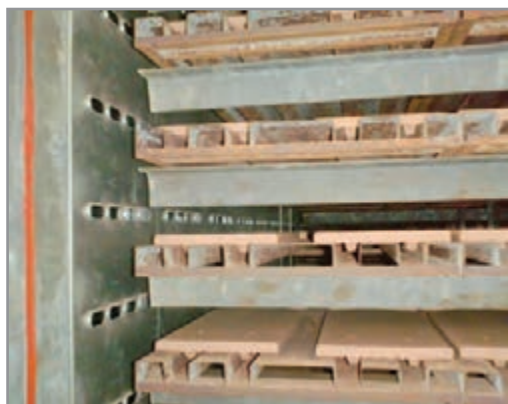
شکل ۱۶- دمش هوا از روزنه ها به قطعه
