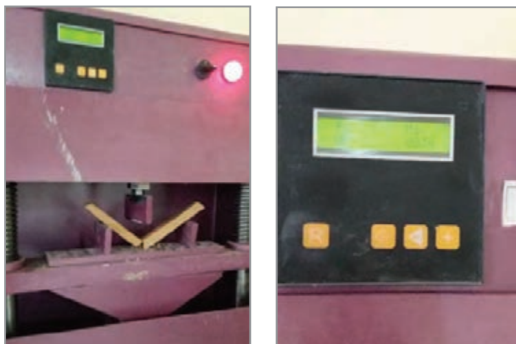
شکل ۲۴- اندازه‌گیری استحکام خمشی خشک نمونه‌ها
