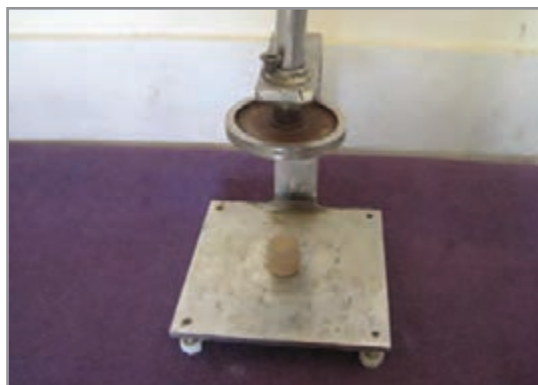
شکل ۶- بررسی ارتفاع ۱۶ میلی‌متر در آزمون ففرکورن
