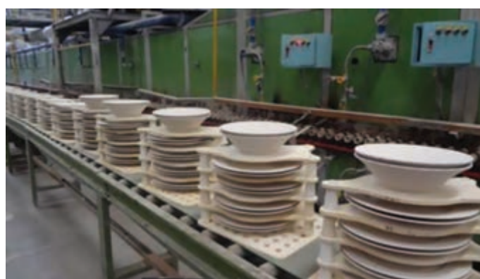
شکل ۴۲- استفاده از سترها برای پخت ظروف
