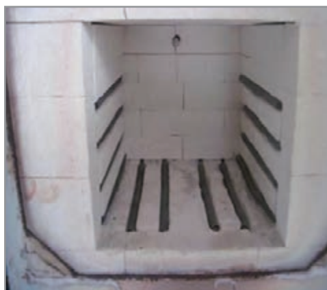
شکل ۱۳- نصب المنت درون شیار
