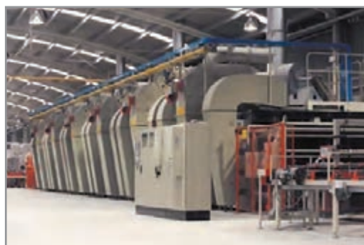
شکل ۱۴- خشک کن تونلی
