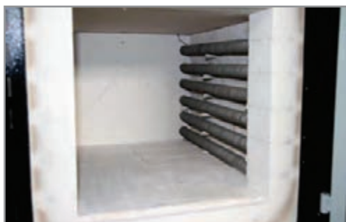
شکل ۱۲- نصب المنت بر روی پایه
