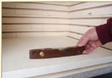
شکل ۲۸- بررسی تراز بودن کف کوره کارگاهی
