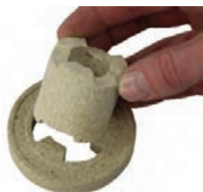
قرار گرفتن اتصال قلعه‌ای بر روی دیسک
