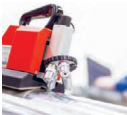
شکل ۳۶- میکروسکوپ کنترل اندازه دیواره سلولها
