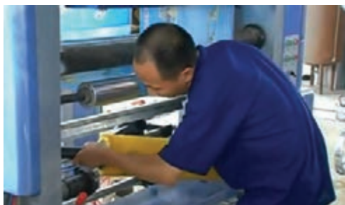
شکل ۶۵- نصب پرس رول سمت موتور
