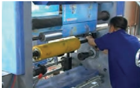
شکل ۶۴- نصب پرس رول سمت اپراتور
