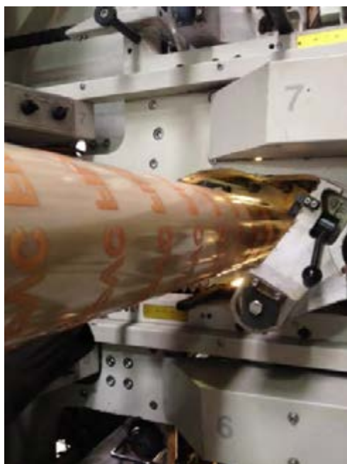
شکل ۳۵- جاگذاری سیلندر کلیشه بر روی آداپتور
