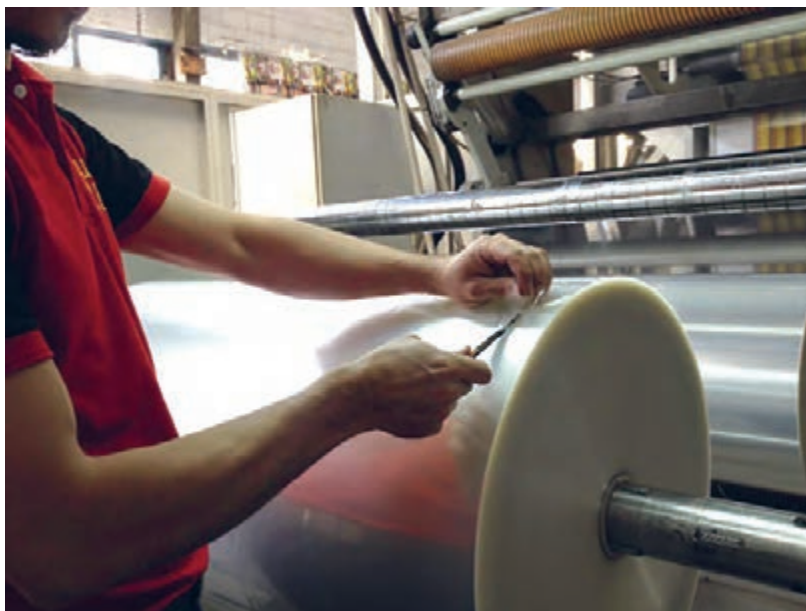
شکل ۱۶- بریدن لایه‌های خراب شده
