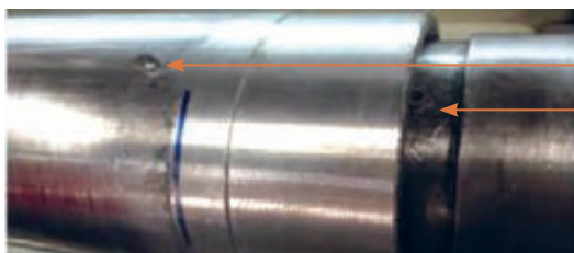
شکل ۱۴- قرار دادن آداپتور روی شفت کلیشه چسبانی
