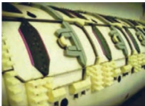
شکل ۱۸- قالب برش گرد یا روتاری
