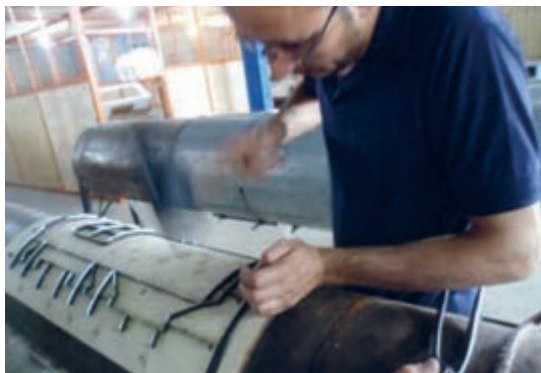
شکل ۱۳۴- جا زدن تیغ‌ها با چکش
