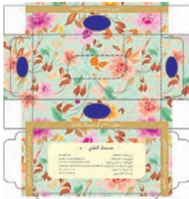
شکل ۲۲- طرح گرافیک و طرح قالب برش جعبه دستمال کاغذی
