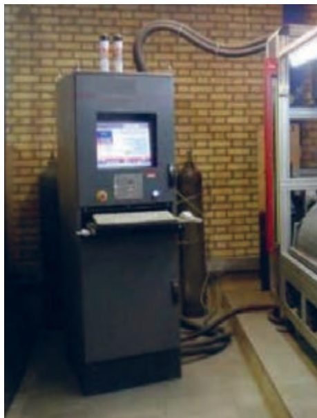
شکل ۱۲۴- ارائه طرح به دستگاه برش لیزری
