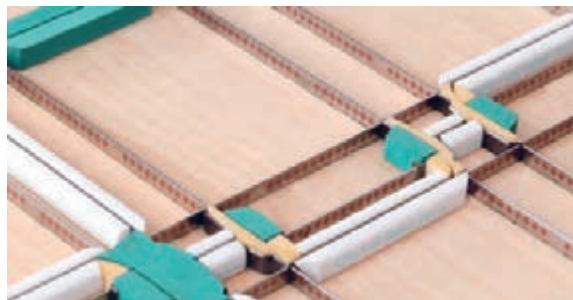
شکل ۱۴۶- هم ترازوی لاستیک‌های جداکننده تیغ‌ها
