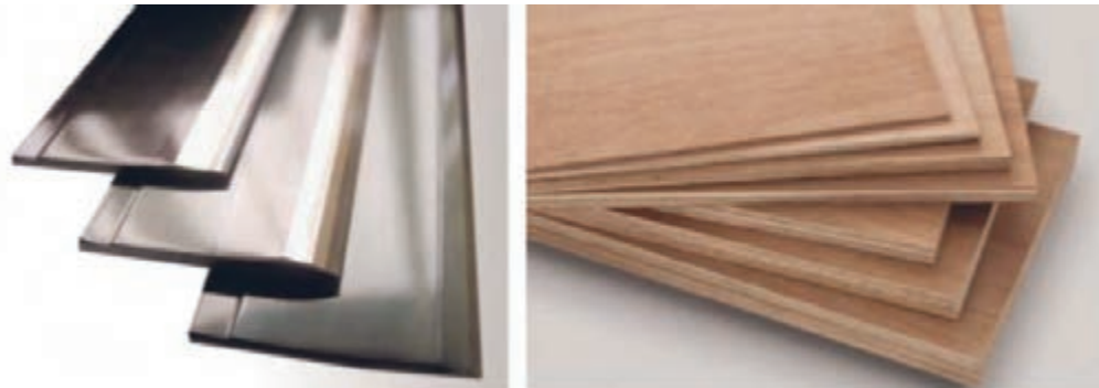
شکل ۱۱- تیغه‌های فولادی قالب برش
