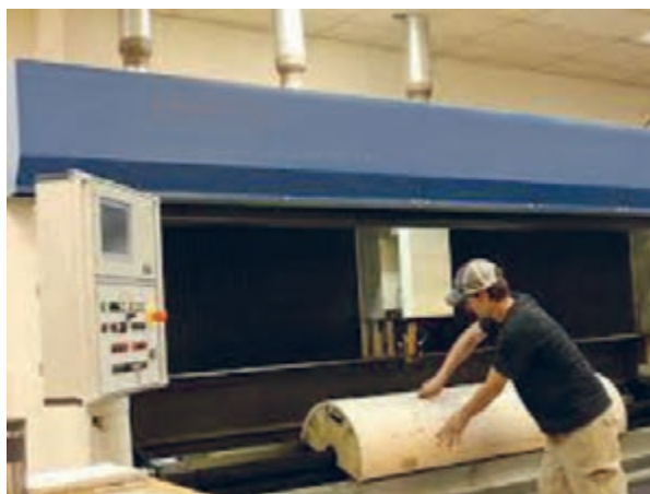
شکل ۱۲۳- قرارگیری سیلندر در دستگاه برش
