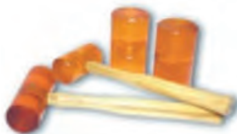
شکل ۱۰۶- چکش و رابط مناسب جای گذاری تیغ‌ها
