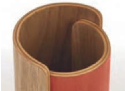
شکل ۱۳- ویژگی انعطاف پذیری تخته‌های چند لایه
