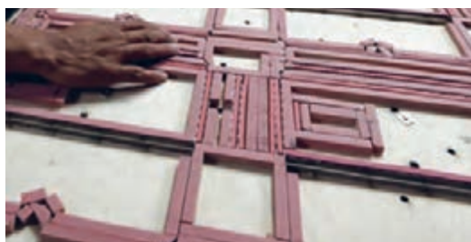
شکل ۱۲۲- قرار دادن لاستیک‌های جدا کننده روی قالب
