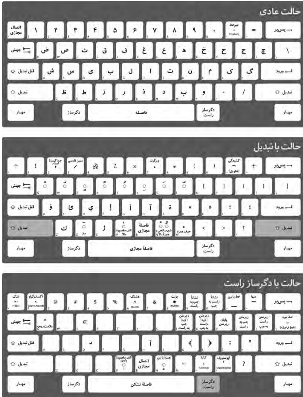
شکل ۷- جزئیات چیدمان صفحه کلید استاندارد فارسی ارائه شده توسط سازمان ملی استاندارد ایران
