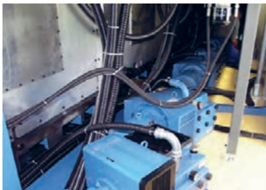
شکل ۳۵- کمپرسور باد دمنده و مکنده
