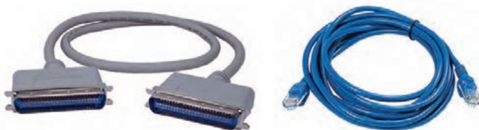
شکل ۲۴- کابل شبکه و کابل SCSI
