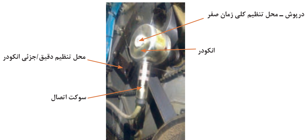
شکل ۲۵- ساختمان یک انکودر در ماشین چاپ
