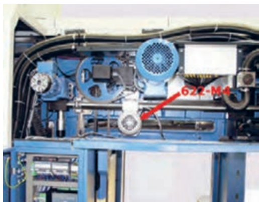
شکل ۳۲- موتور AC بالا و پایین بردن تخته کاغذ
