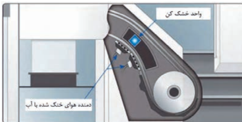
شکل ۳- الف) فضای کمتر برای لامپ H-UV
