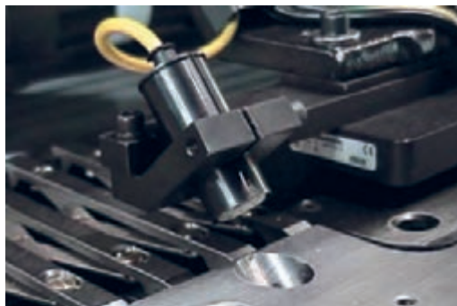
شکل ۱۵- سنسور دوتایی بگير اولتراسونیک
