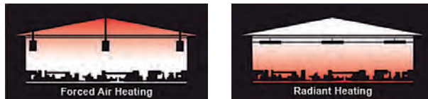
شکل ۷- مقایسه گرمایش تابشی با یونیت هیتر
