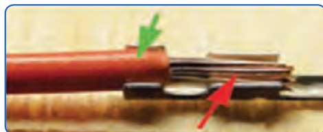
شکل ۱۱- جازدن سر سیم در سیم افشان
