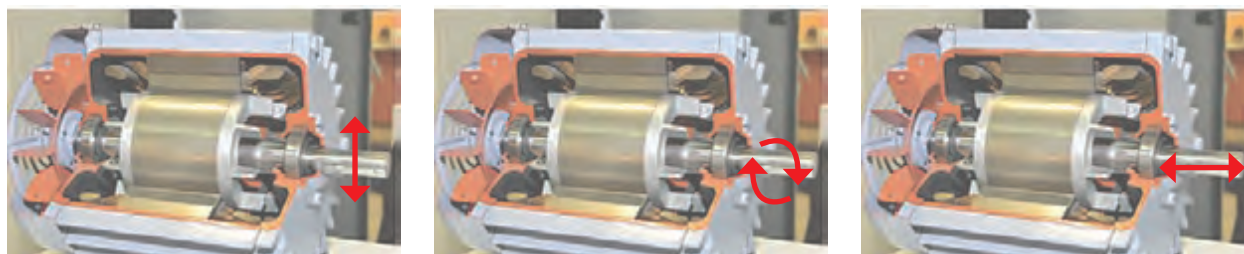
شکل ۱۸- کنترل ظاهری بلبرینگ موتور یونیت هیتر
