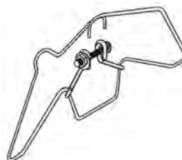
بست اتصال رفلکتور و لوله
