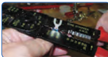
شکل ۱۲- پرس کردن عایق سیم به سر سیم با دستگاه پرس
