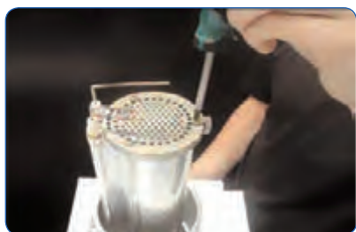
بازکردن شعله پخش کن و الکتروود و تمیزکردن
