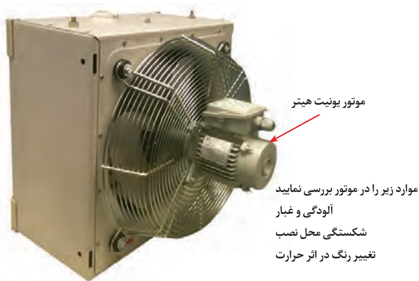
شکل ۱۹- کنترل ظاهری موتور یونیت هیتر
