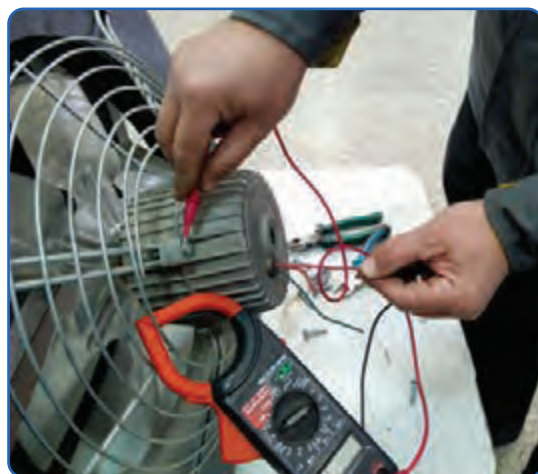
شکل ۲۰- اندازه گیری مقاومت اهمی موتور یونیت هیتر
