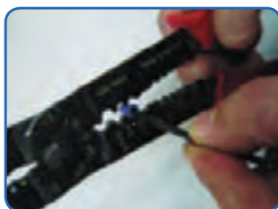
شکل ۱۲- پرس کردن عایق سیم به سر سیم با دستگاه پرس
