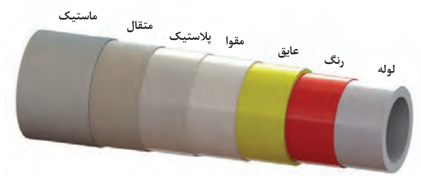
شکل ۱۳- لایه های عایق پشم شیشه
