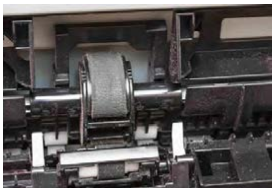
شکل ۳-۲۰- محل غلتک کاغذ کش در داخل پرینتر
