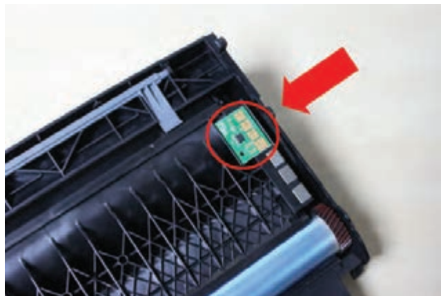
شکل ۴۶-۳- کارتریج مجهز به برد چیپ ست
