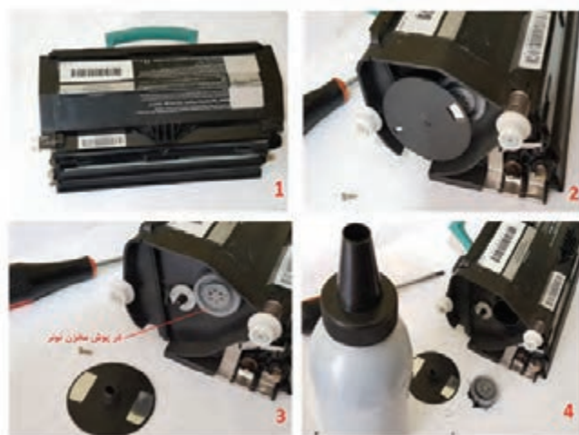
شکل ۴۸-۳- مراحل شارژ یک نمونه کارت‌تریج لیزری
