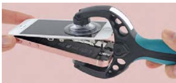
شکل ۵-۳۵- جدا کردن صفحه لمسی با ابزار وکیوم
