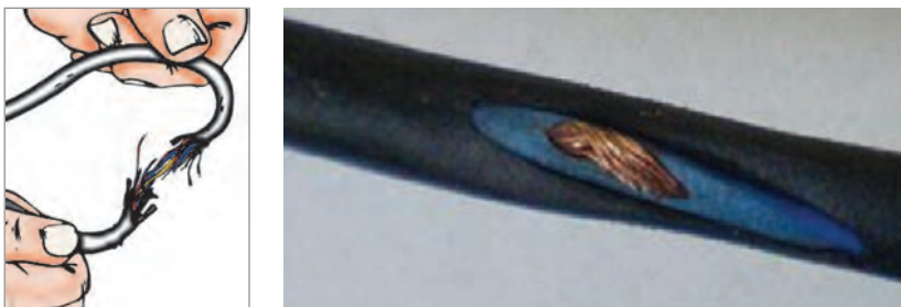
شکل ۱۸-۳- پوسیدگی و زخمی شدن سیم‌ها و کابل‌ها
