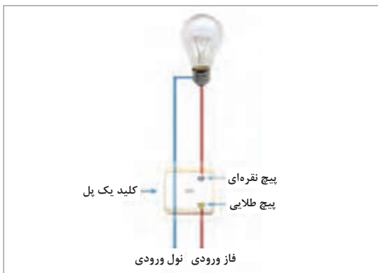
شکل ۳-۳۵- مدار الکتریکی کلید یک پل
