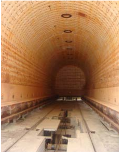
کوره عملیات حرارتی صنعتی با ابعاد بزرگ
