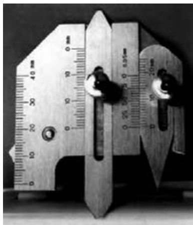
شکل ۳- ابزار اندازه گیری بعد جوش
