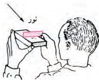
شکل ۱-۲۳- کنترل زاویه قائمه با گونیا
