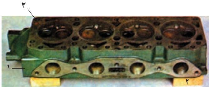
۱- سرسیلندر ۲- قطعه چوب ۳- نشیمنگاه
