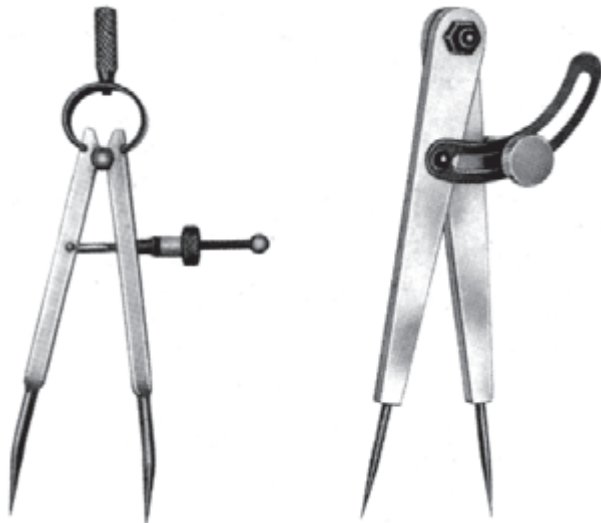
الف - پرگار ساده با پیچ تثبیت
