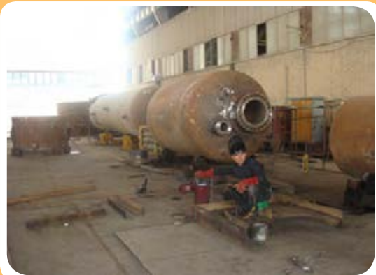
ب) کارگاه ساخت مخازن تحت فشار
