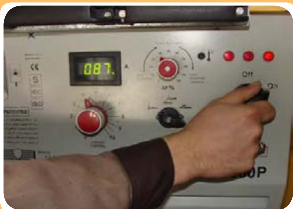
کلیدهای مختلف روی صفحه اصلی رکتی‌فایر جوشکاری
