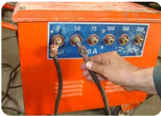
تنظیم آمپر در دستگاه ترانسفورماتور پله‌ای
