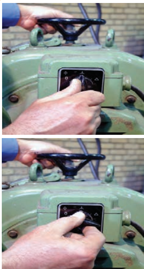
دینام جوش کارگاهی و کلیدهای مخصوص روشن و خاموش کردن دستگاه
