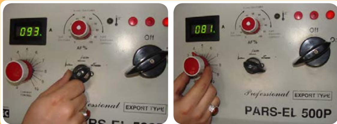
کلیدهای مختلف برای تنظیم دستگاه جوشکاری
