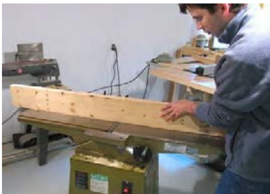
شکل ۴-۲۴ - پس از رندیدن (۹)، باید نرِ چوب را نیز رنده کرد.
