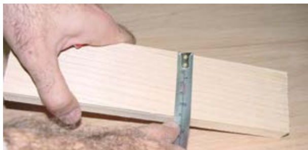
شکل ۳۶-۷- اندازه‌گیری نهایی قطعه کار.
