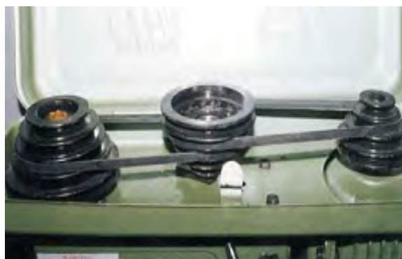
شکل ۱۹-۱۳. تغییر دور پله‌ای در دستگاه دریل ستونی.
