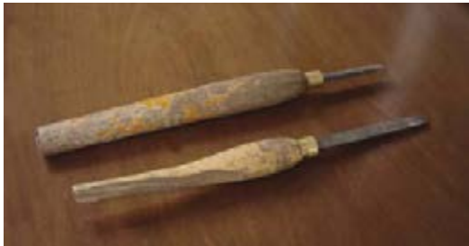
شکل ۱۱-۲۰- نمونه‌ای از مغارهای با دسته‌ی معیوب.
