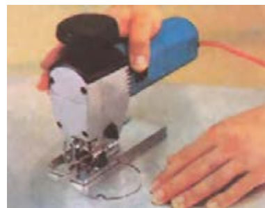
شکل ۱۵-۲۵- دایره‌بُری بدون گونیا (محل دایره قبلاً با پرگار مشخص شده است).
