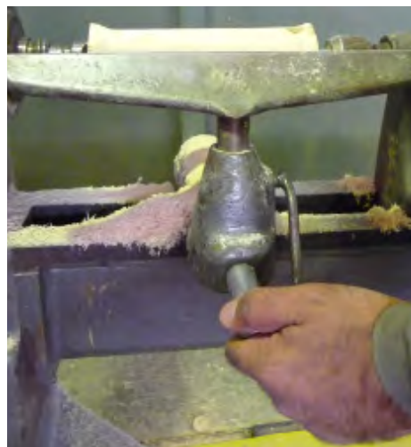
شکل ۱۱-۲۵- تکیه‌گاه کوتاه، و تنظیم ارتفاع و فاصله‌ی افقی آن نسبت به قطعه چوب فراطی.
