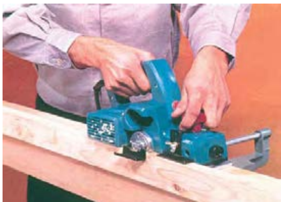
شکل ۱۴-۳۳- تکرار عمل رندیدن چوب، برای به دست آوردن دوراهه‌ی مورد نظر.
