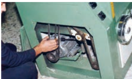
شکل ۲۶-۷- کنترل سفتی تسمه‌ی انتقال نیرو.
