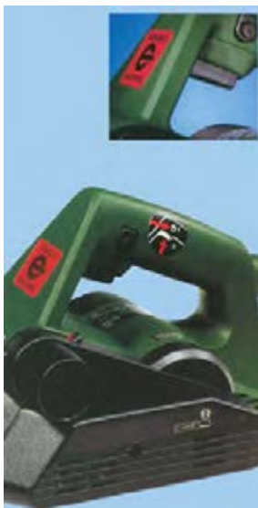
شکل ۱۴-۳- کلید قطع و وصل برق و قفل‌کن آن (روی بدنه‌ی رنده).
