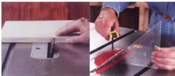
شکل ۱۲-۱۷- کنترل زاویه با گونیا و یا خط مورب ترسیم شده روی قطعه کار.
