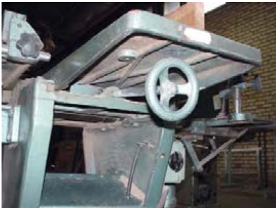
شکل ۳-۶- پیچ فلکه‌ی تنظیم صفحه را باید با گازوییل شستشو نمود.
