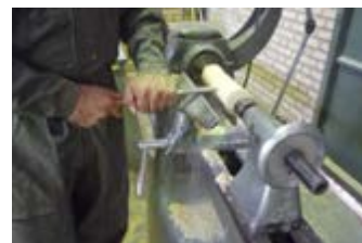
شکل ۱۱-۳۱- صاف کردن چوب گرد شده به کمک مغار مورب پهن.
