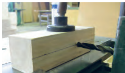
شکل ۹-۱۸- تنظیم نیش مته با فط وسط چوب.
