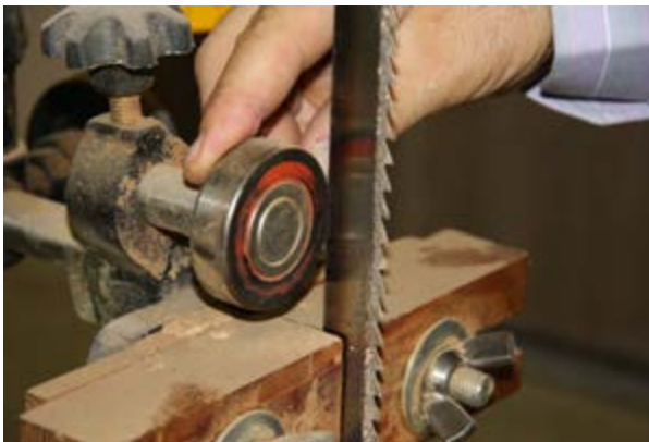
شکل ۳۰-۱- کنترل بلبرینگ پشت تیغه.
