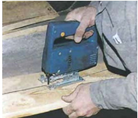
شکل ۱۹-۱۵. برش طولی چوب بدون استفاده از گونیا.
