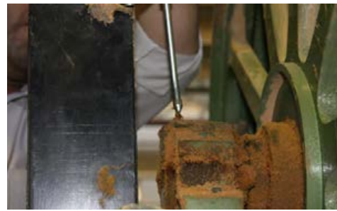
شکل ۳-۱۳- گریس کاری یاتاقان فلکه اره.
