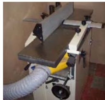
شکل ۴-۲۲ - مکندهی قابل اتصال به ماشین کفرنده.
