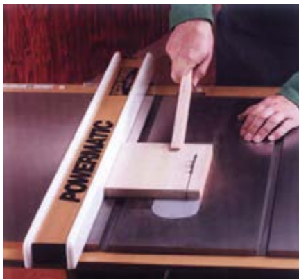
شکل ۱۲-۳۷- استفاده از چوب کمکی سافته شده در کارگاه.
