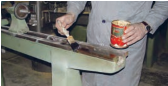
شکل ۱۱-۴۵- تمیزکاری قسمت‌های ضروری و بدون رنگ ماشین.
