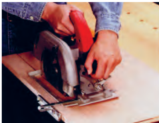
شکل ۱۳-۱۶. برش با استفاده از گونیای ماشین.
