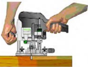
شکل ۱۶-۲۶- دوراهاه (زدن قطعه کار با دستگاه اورفرز).
