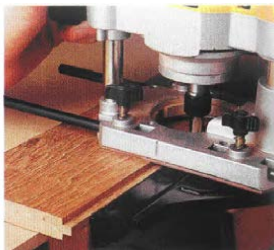
شکل ۱۶-۴. دوراهه زدن، با دستگاه اورفرز.
