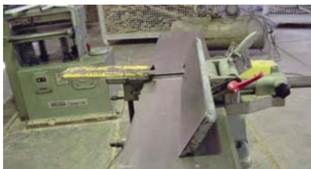
شکل ۳۴-۴- تنظیم زاویه ۴۵ درجه گونیا‌ی رنده.
