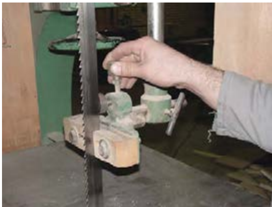
شکل ۵۲-۱- نمونه‌ی تنظیم فاصله‌ی بلبرینگ با پشت تیغه.
