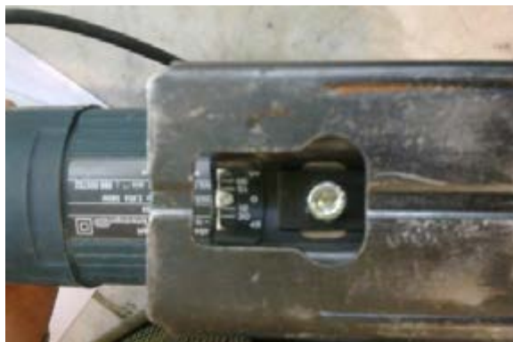
شکل ۱۳-۱۵. قسمت مدرج صفحه‌ی دستگاه اره عمودبر.
