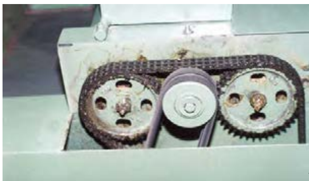
شکل ۱۸-۷. زنجیر انتقال نیرو و قدرت به غلتک‌ها.
