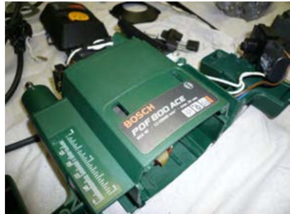
شکل ۱۶-۹- بدنه یا جلد دستگاه اورفرز.
