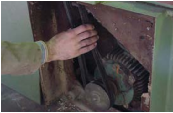
شکل ۱۳-۶- سفتی تسمه را بررسی کنید.
