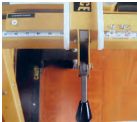
شکل ۱۲-۲۳- تنظیم اندازه‌ی برش.
