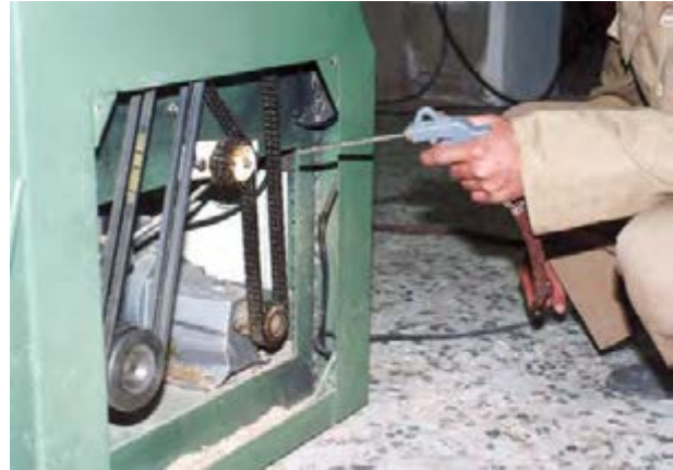
شکل ۸-۱۵- بادگیری دافل قسمت انتقال نیرو.
