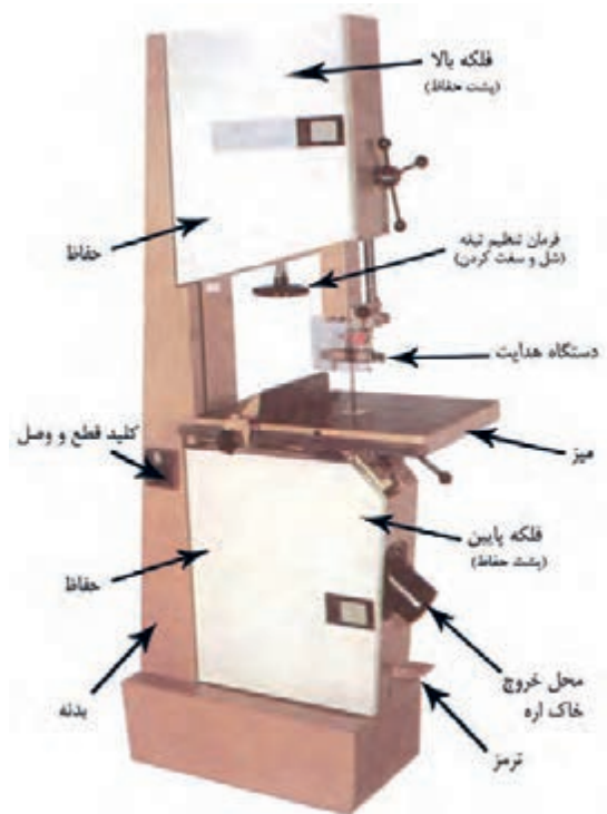
شکل ۱-۴. قسمت‌های مختلف یک ماشین اره‌نواری.
