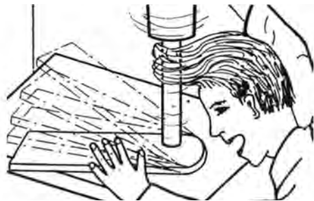
شکل ۱۹-۲۶- درگیر شدن مته با موی سر.
