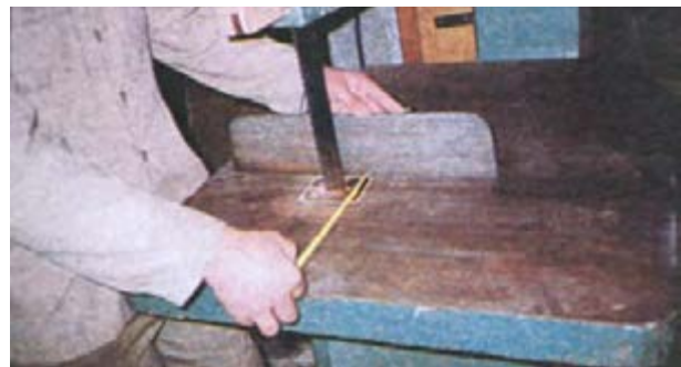
شکل ۱-۴۳-۱- اندازه‌گیری فاصله تیغه با گونیا.
