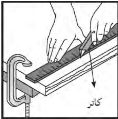
شکل ۲۱-۱۵. تعیین مسیر برش توسط فلکاش و کاتر (در برش بدون گونیا)
