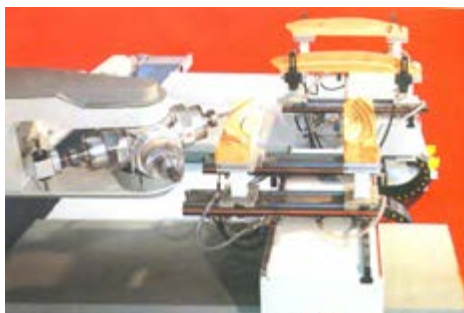
شکل ۷- دستگاه CNC کنده‌کاری بر روی چوب.
