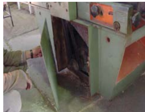
شکل ۱۴-۴- مفاظ الکتروموتور و تسمه‌ها.
