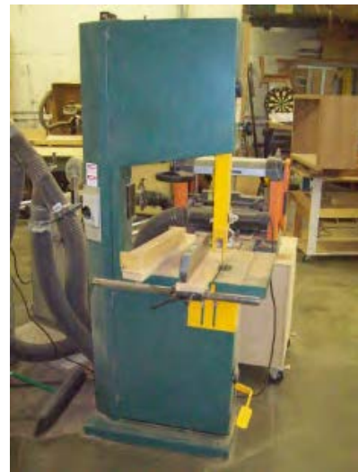
شکل ۹-۱. یک ماشین اره‌نواری، با مفاظ کامل.
