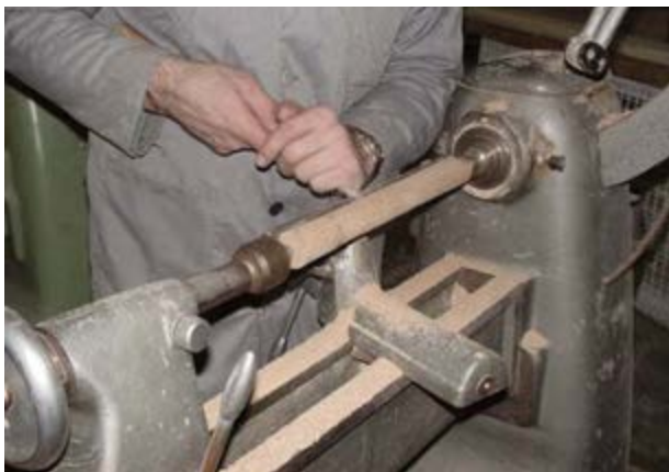
شکل ۱۱-۲۷- نمونه‌ی قرار گرفتن مغار گلوبی هنگام فراطی.
