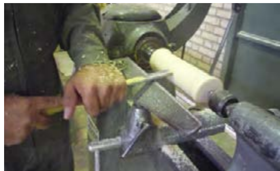
شکل ۱۱-۱۳- مغار نیم‌گرد گلوبی و نمونه‌ی کار با آن.
