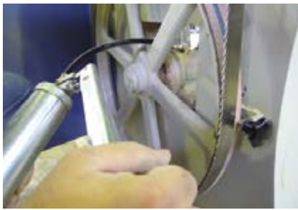
شکل ۳-۳- گریس کاری کتسو جابجایی فلکه‌ی بالا.
