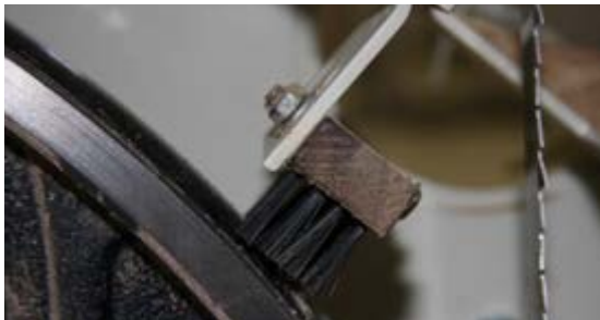
شکل ۸-۱- برس غبارگیری روی بانداژ فلک.
