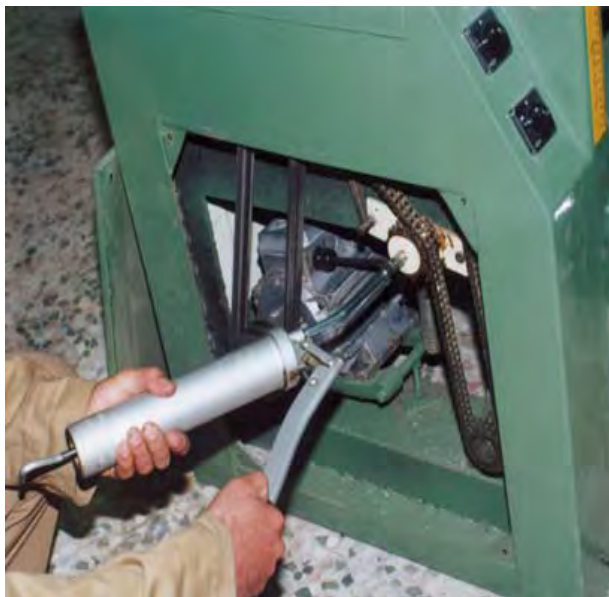
شکل ۸-۷- گریس‌کاری ممبرهای انتقال نیرو.
