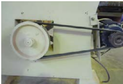
شکل ۳-۱۷- استقرار تسمه در داخل چرخ تسمه.
