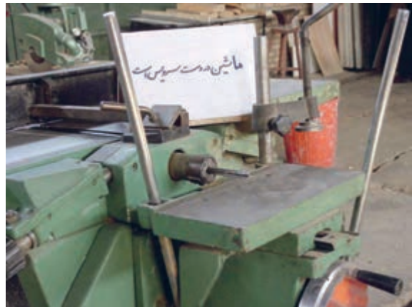
شکل ۱۰-۸- تابلوی هشدار سرویس‌کاری.
