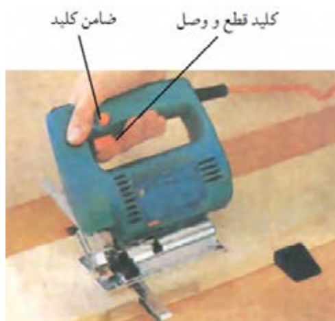
شکل ۱۴-۱۵- کلید قطع و وصل و ضامن کلید.
