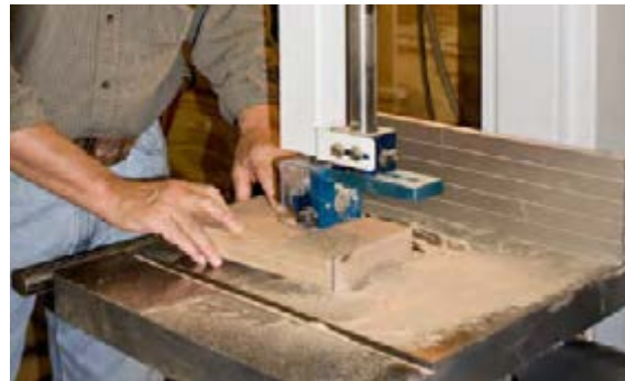
شکل ۱-۳۵-۱- فاصله‌ی ارتفاع سطح چوب با دستگاه هدایت.
