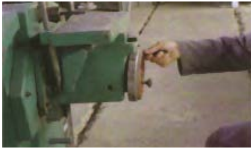
شکل ۱۰-۳- میله و سیستم تنظیم ارتفاع صفحه‌ی متمرک.
