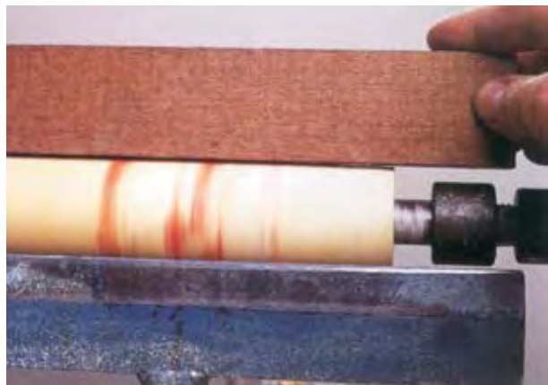
شکل ۱۱-۵۱- کنترل صافی قطعه چوب گرد شده.
