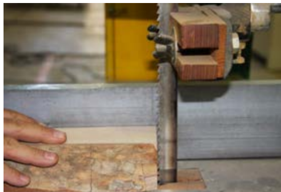
شکل ۳۲-۱- شرایط ایمنی دست، هنگام کار با اره.
