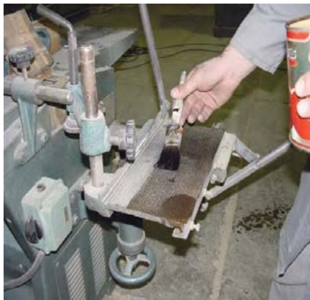
شکل ۱۰-۱۲- چرب کردن صفحات با روغن.
