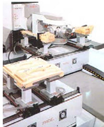
شکل ۱۰- دستگاه C.N.C نمونه کار ابزار فوردهی کامل که آماده‌ی مونتاژ است.
