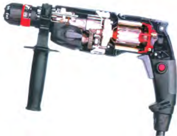
شکل ۱۹-۴۵- وضعیت قرارگیری قطعات در داخل پوسته‌ی دریل.
