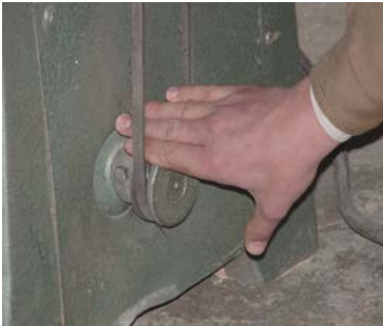
شکل ۱۰-۶- مراقبت از انگشتان به هنگام تعویض تسمه.
