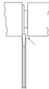
شکل ۱۱-۱۶- مغار نیزه‌ای یا قطع‌کن؛ برش عرضی.
