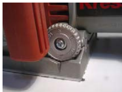
شکل ۱۷-۵- پیچ تنظیم عمق شیار.
