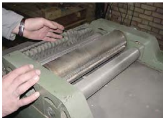
شکل ۷-۲۹- کنترل تمیزی شانه‌ها.
