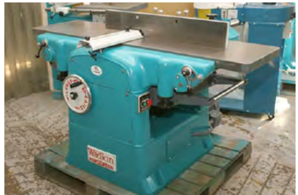
شکل ۴-۴- ماشین کفرند با بدنه چدنی.
