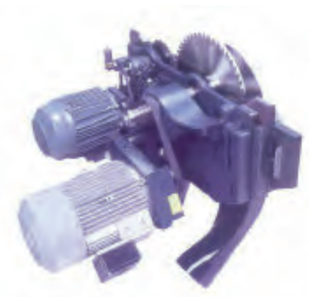
شکل ۱۲-۷- الکتروموتور و سیستم انتقال نیرو.
