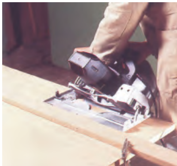
شکل ۱۳-۱۲- صفحه‌ی دستگاه تمت زاویه تنظیم شده است.
