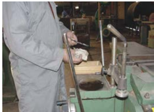
شکل ۱۰-۵- (روغن‌کاری و تمیز کردن مته‌ها).
