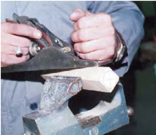
شکل ۱۱-۲۴- پیغ زدن گوشه‌های تیز چوب.
