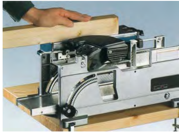
شکل ۱۴-۲۰- کاربرد میز کمکی در موقع رندیدن.
