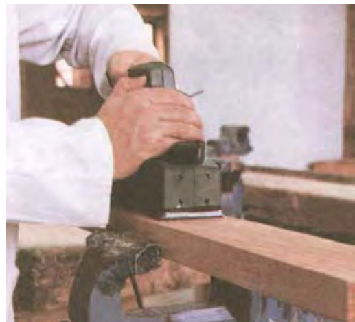
شکل ۱۷-۱۴. نمونه‌ی بستن چوب دافل گیره
