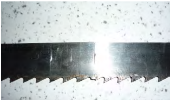
شکل ۷۰-۱- ترک تیغه اره از محل جوش.
