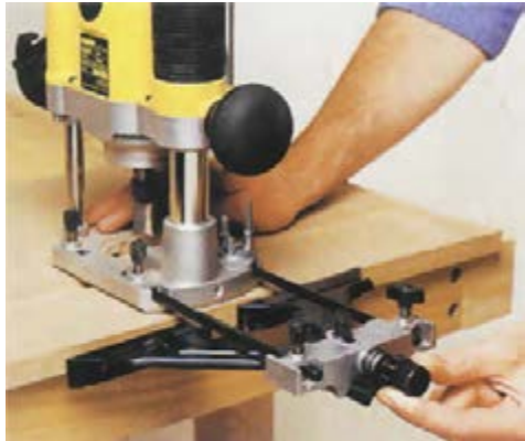
شکل ۱۶-۲۱- تنظیم گونیا هنگام کار با تیغه‌های بدون غلتنک
