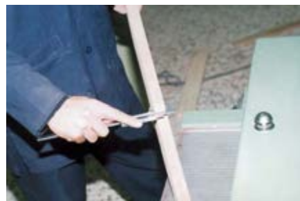
شکل ۴۸-۷- کنترل ضخامت چوب گندگی شده، با کولیس.
