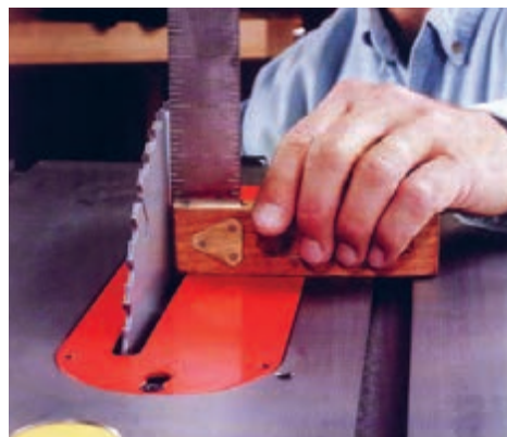
شکل ۱۲-۲۲- کنترل و تنظیم گونیا‌یی بودن تیغه.
