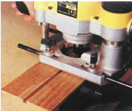
شکل ۱۶-۳. کنشکاف زدن، با دستگاه اور فرز.
