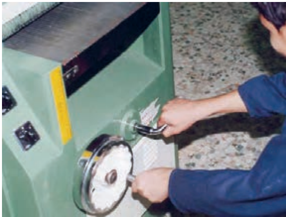
شکل ۷-۳۴- تنظیم مقدار بار گندگی.
