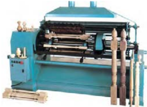
شکل ۱۱-۳ - ماشین فرای تمام اتوماتیک
