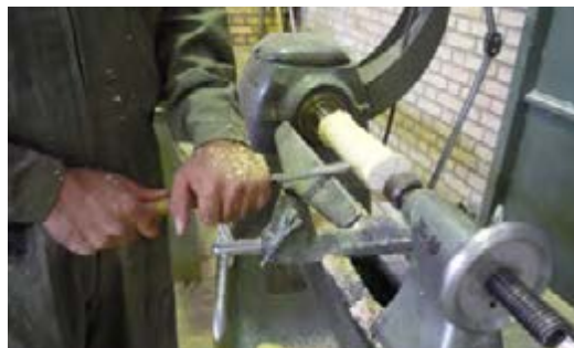
شکل ۱۱-۵۵. نمونه‌ی گرد کردن قطعه چوب پف‌مورده.
