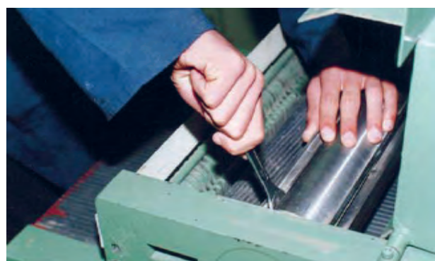
شکل ۲۴-۷- نمونه‌ی بستن تیغه‌ها به توپی.
