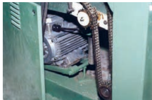
شکل ۱۳-۷ ب. حفاظ تسمه، زنجیر، الکتروموتور و ...
