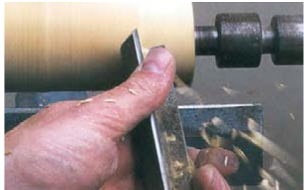
شکل ۱۱-۵۰- گرد کردن نهایی چوب با مغار گلویی.
