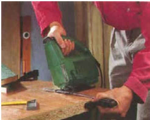
شکل ۲۲-۱۵. نمونه‌ی برش تحت زاویه به کمک گونیا (اره پکشی).
