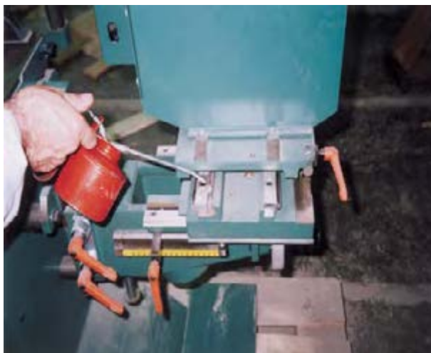
شکل ۱۰-۱۳- (روغن‌کاری) ممل (ریل‌ها).
