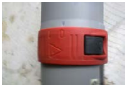
شکل ۱۷-۷ - کلید قطع و وصل دستگاه فرز بیسکویتی
