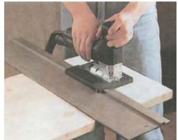
شکل ۲۰-۱۵. برش عرضی چوب به کمک ریل راهنما.
