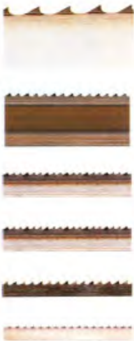
شکل ۱۴۸-۱. فرم‌های مختلف دندانه‌ی اره‌نواری.
