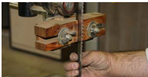
شکل ۳۴-۱- کنترل لازم تیغه قبل از کار.
