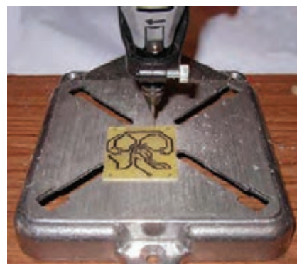
شکل ۷-۸ سوراخ کاری با دریل برقی
