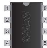
ج - دو نوع محفظه آی سی شکل ۸-۶۵ آی سی تایمر ۵۵۵
