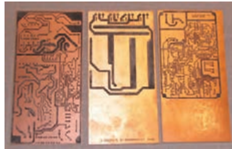
شکل ۷-۶ انتقال مدار چاپی روی فیبر
