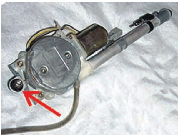
شکل ۵-۲۲- آنتن الکتریکی پس از پیاده کردن آن
