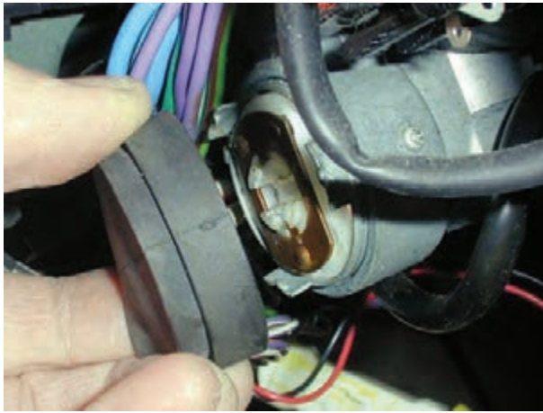
شکل ۱۱-۱۳- بیرون آوردن فیبری پشت سوئیچ
