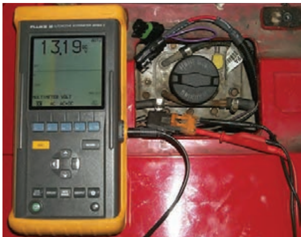
شکل ۴۶-۸ اندازه گیری ولتاژ مدار
