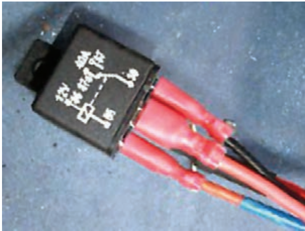
شکل ۸-۴۷- رله‌ی مورد استفاده در مدار الکتریکی پمپ بنزین
