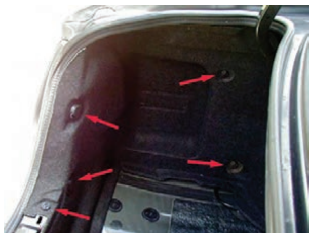
شکل ۲۰-۵- خارهای پلاستیکی کاور صندوق عقب
