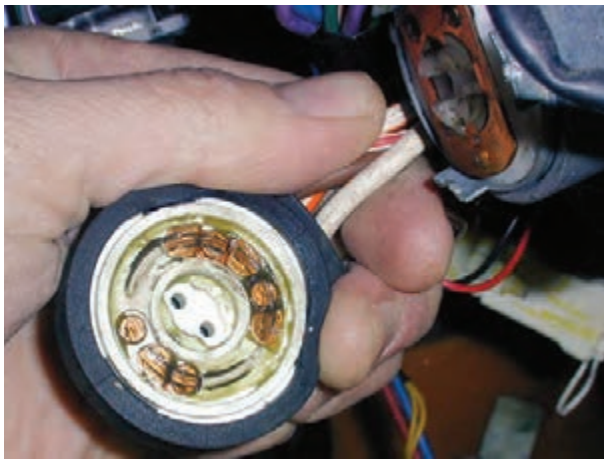
شکل ۱۱-۱۴- ترمینال داخل فیبری سوئیچ
