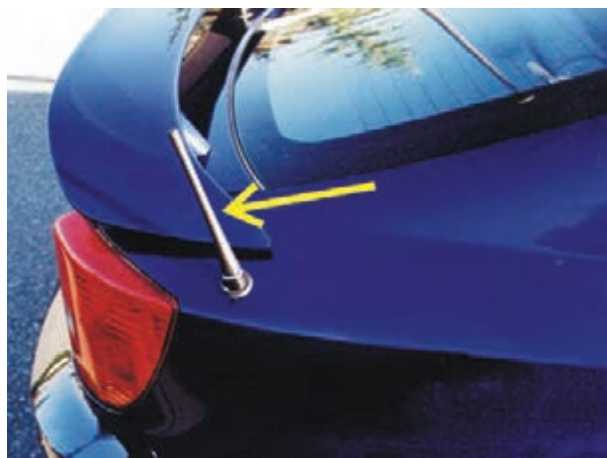
شکل ۱۶-۵- باز شدن میله‌ی آنتن
