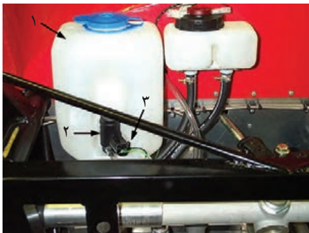
شکل ۲-۷- مخزن و پمپ آب شیشه شوی
