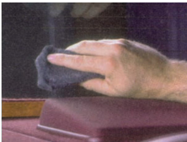
شکل ۳-۲۲- تمیز کردن محل قطع شده‌ی المنت حرارتی
