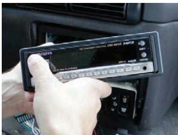
شکل ۲۸-۴ - خارج نمودن رادیوپخش از داخل قاب کنسویی
