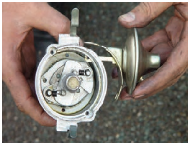
شکل ۳۱-۱۰ جدا کردن مجموعه‌ی آوانس خلئی
