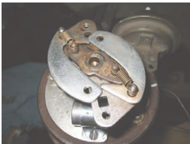
شکل ۲۴-۱۰- دستگاه آوانس وزنه‌ای دلکو
