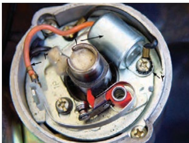
۱- خازن ۲- پیچ اتصال بدنه خازن ۳- سیم مثبت خازن
