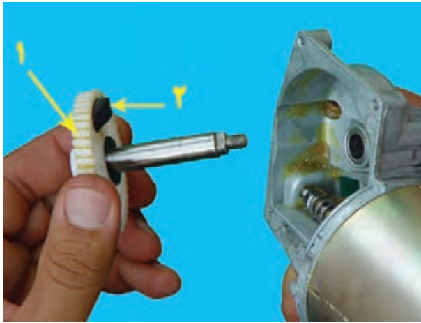
۱- چرخ دنده ۲- بادامک محرک زائده پلاتین
