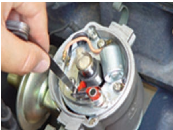
شکل ۴۸-۱۰- قرار دادن فیلر در دهانه‌ی پلاتین
