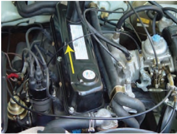
شکل ۲۸- ۱۰- لوله‌ی رابط آوانس خلی‌ به کاربراتور
