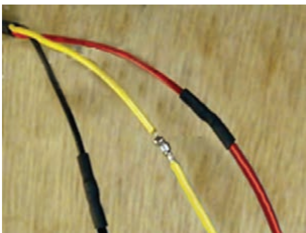
شکل ۱-۷۴- رفع عیب سیم کشی مدار الکتریکی
