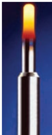
شکل ۳-۱۳- شمع گرم کن در حالت گداخته بودن
