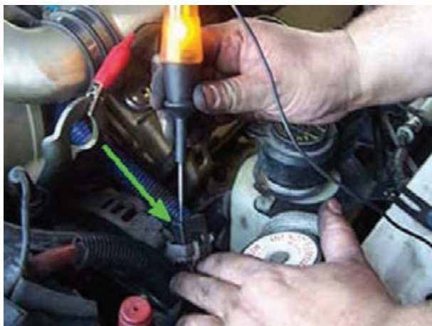
شکل ۱-۷۳- آزمایش سیم کشی مدار
