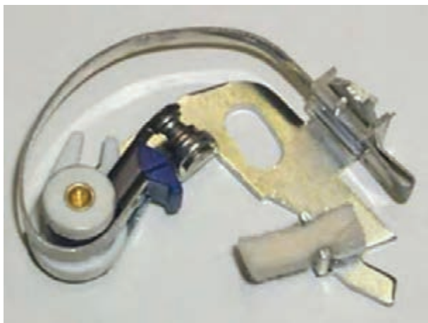
شکل ۲۲-۱۰- نمد روغن کاری بادامک
