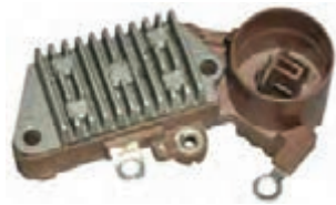
تنظیم کننده شارژ باتری با استفاده از دیود زنر و سایر قطعات الکترونیکی
