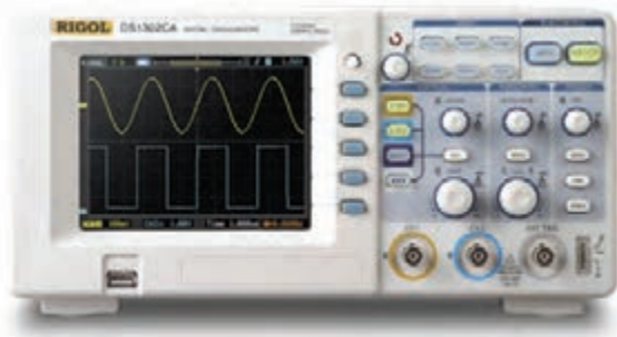
شکل ۱۳۲-۲. اسیلوسکوپ دو کاناله دیجیتال. اسیلوسکوپ دو کاناله می‌تواند و شکل موج را به‌طور هم‌زمان روی نمایش‌گر نشان دهد.
