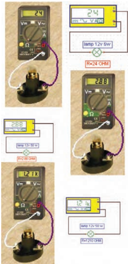
شکل ۸۹-۲- اندازه گیری مقاومت لامپ‌های روشنایی
