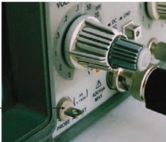
شکل ۱۱۶-۲- این ترمینال روی اسیلوسکوپ قرار دارد و سیگنال مربعی با دامنه‌ی 5/0 تا یک ولت و فرکانس یک کیلوهرتز تولید می‌کند.
