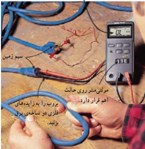
شکل ۲-۸۰ - آزمایش سیم رابط برق دستگاه.
