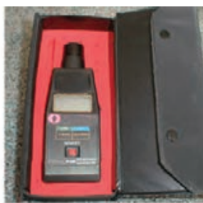
دورسنج دیجیتالی با محرک مکانیکی
