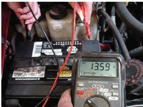
شکل ۱-۵۰ اندازه‌گیری ولتاژ با ولت‌متر دیجیتال
