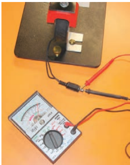
شکل ۸۴-۲-ج - آزمایش به وسیله‌ی اهم متر عقربه‌ای
