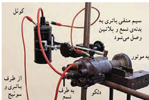
شکل ۱۴۴-۲- مدار شبیه‌سازی شده‌ی سیستم جرقه‌زنی
