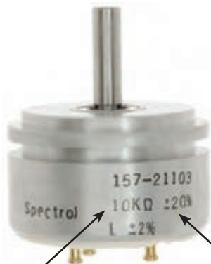
تولرانس 20\% درصد مقدار مقاومت 10\ \text{کیلو اهم} است
