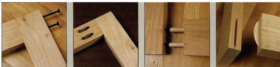
تصویر مجسم اتصال گوشه‌ای بیسکوییتی ساده تصویر مجسم اتصال دوپل تصویر مجسم اتصال گوشه‌ای مورب با پیچ تصویر مجسم اتصال با پیچ چوب
