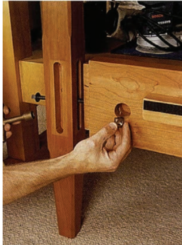
شکل (۵-۲۲) اتصال قید به پایه تختخواب به وسیله یراق فیتینگ (پیچ و مهره)
