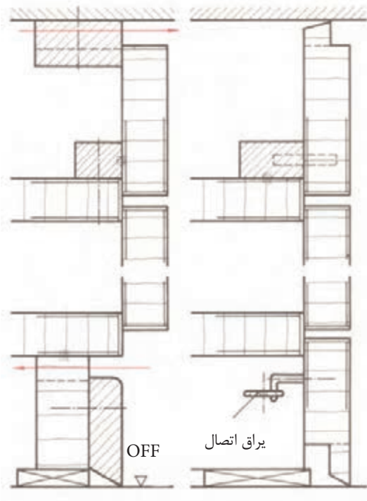
شکل (۳-۱۷۲) ترسیم نقشه برش طولی کابینت دیواری با پوشش پاسنگ و سقف اتاق
