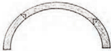
شکل (۳-۱۳۴) اتصال طولی قطعات قوس دار
