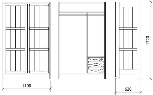
شکل (۳-۸۶) ترسیم نماهای کابینت با تقسیمات داخل آن
