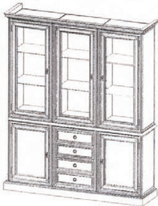
شکل (۳-۴۸) تصویر مجسم کابینت مرکب به ارتفاع ۲۰۶، عرض ۱۶۲ و عمق ۴۷/۵ سانتی‌متر
