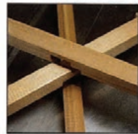
شکل (۵-۹۸) اتصالات متقاطع با زوایای مختلف ۹۰ درجه و کمتر یا بیش‌تر
