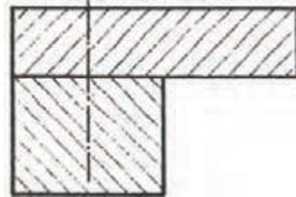
شکل (۴-۲) هاشور دو قطعه چوب توپر مخالف هم زده شده است.
