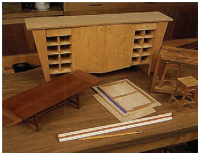
شکل (۶۳-۳) نمونه مدل‌های ساخته شده به منظور رفع اشکالات برای ساخت نمونه اصلی
