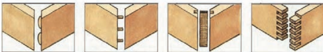
شکل (۵-۴۷) اتصال گوشه‌ای تصویر مجسم اتصالات انگشتی، قلیف زبانه جدا، دوپل و بیسکویتی
