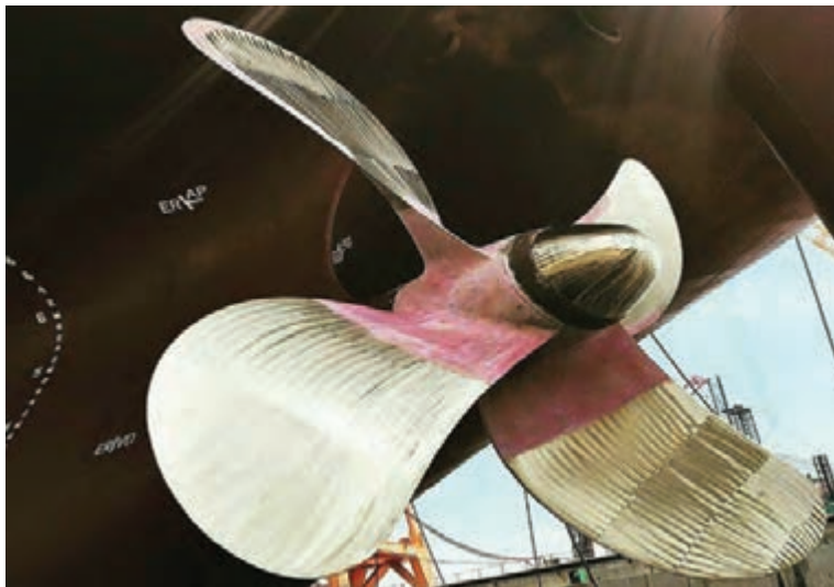
شکل ۱۳- پروانه کشتی با چهار پره
