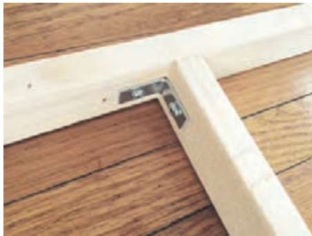
شکل ۲۱- اتصال با بست گونیایی
