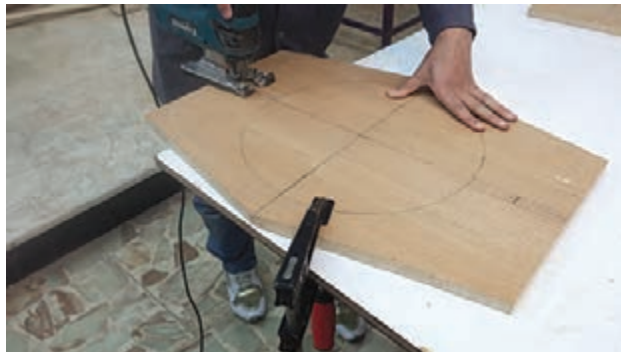
شکل ۴۹- محکم بستن قطعه کار
