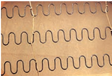
شکل ۷۴ - فنر زیگزاگ (سینوسی)
