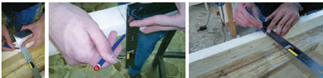
شکل ۴۵- انتقال اندازه‌ها به قطعه دوم
