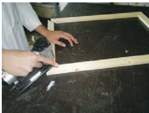
شکل ۲۷-منگنه زدن گوشه‌های دیگر قاب
