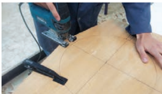
شکل ۵۶- برشکاری از محل اتصال پایه‌ها
