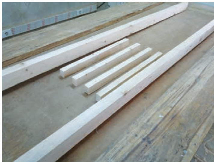
شکل ۳۹- قطعات پاراوان (۲ قید طولی و ۴ قید عرضی)
