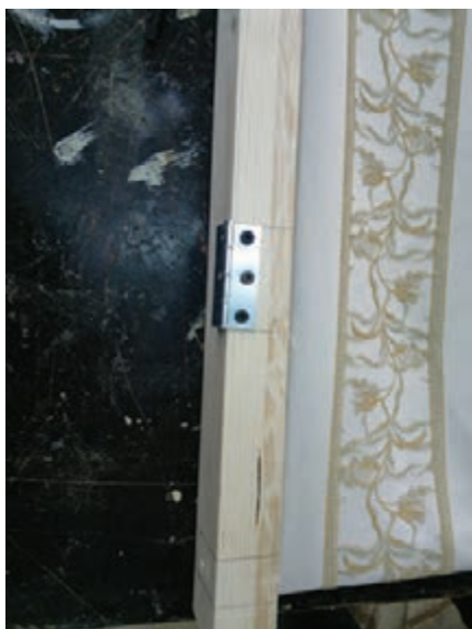
شکل ۷۲- محکم کردن برگه اول لولا با ۳ پیچ
