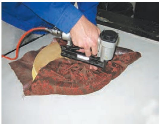
شکل ۱۱۷- منگنه زدن چهارطرف و ثابت کردن پارچه
