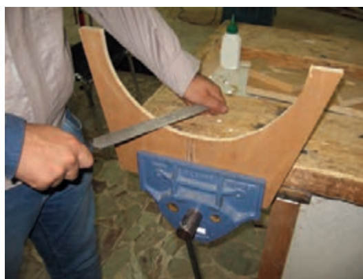
شکل ۶۳- پرداخت با چوبسای زبر
