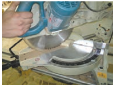
شکل ۲۰- برش فارسی یا ۴۵ درجه باره فارسی بر
