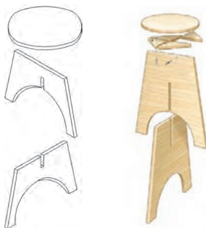
شکل ۳۰- نقشه انفجاری چهارپایه
