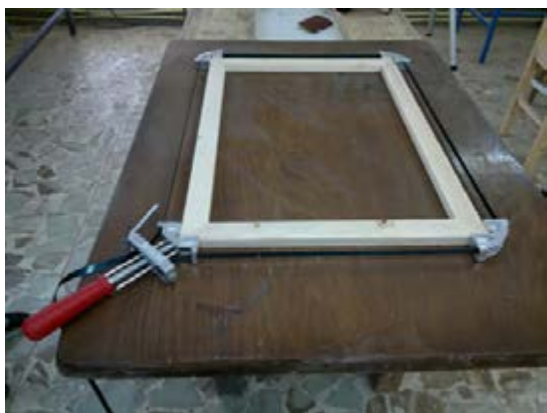
شکل ۳۰- بستن قاب با استفاده از گیره تسمه‌ای
