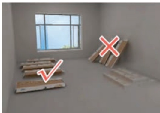
شکل ۲۶ و ۲۷- نحوه قرار دادن درست جعبه های لمینت
