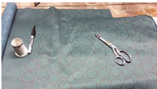
شکل ۶۴- خط‌کشی برای دکمه روی چرم مصنوعی
