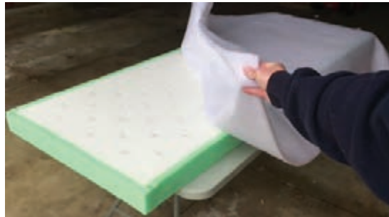
شکل ۶۰- پوشش اسفنج با یک لایه گان
