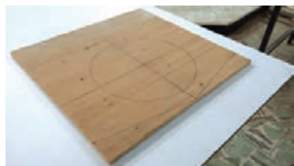
شکل ۳۷- ترسیم دایره بر روی تخته چندلایه
