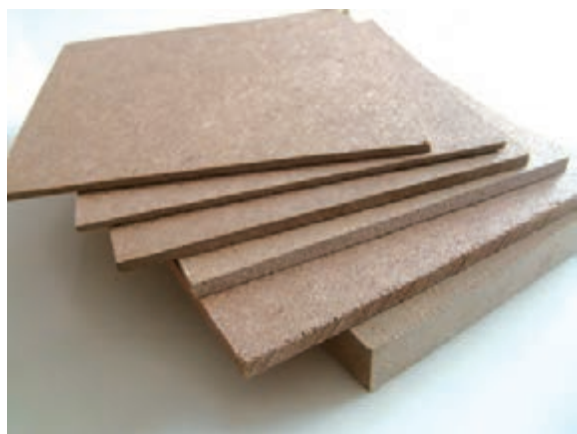
شکل ۷- تخته فیبر در ضخامت‌های مختلف
