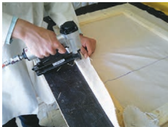
شکل ۳۳- منگنه زدن وسط قاب
