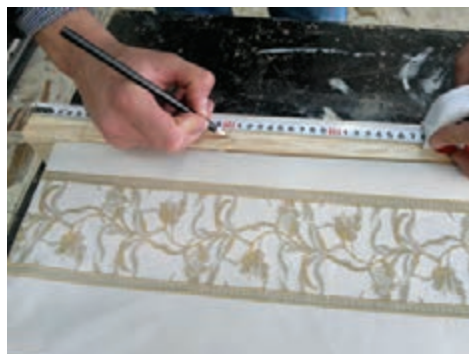
شکل ۶۶- اندازه گیری محل لولا
