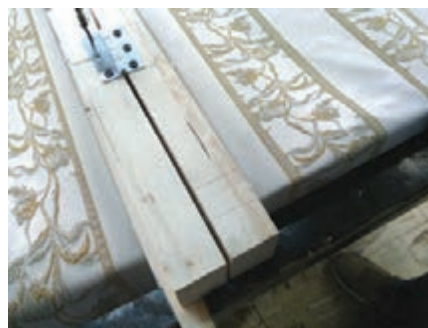
شکل ۷۴- بستن پیچ دوم برگه دوم لولا
