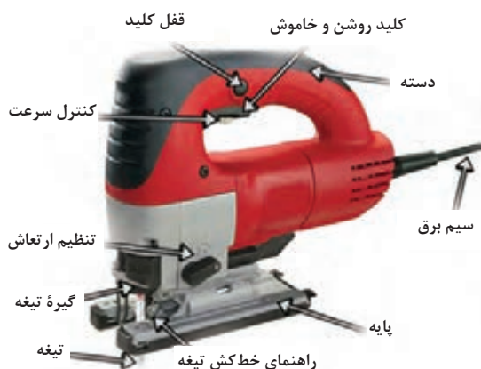
شکل ۴۰- قسمت‌های مختلف اره عمودبر
