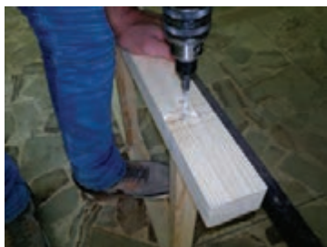
شکل ۵۴- سوراخ کاری جای پیچ دوم
