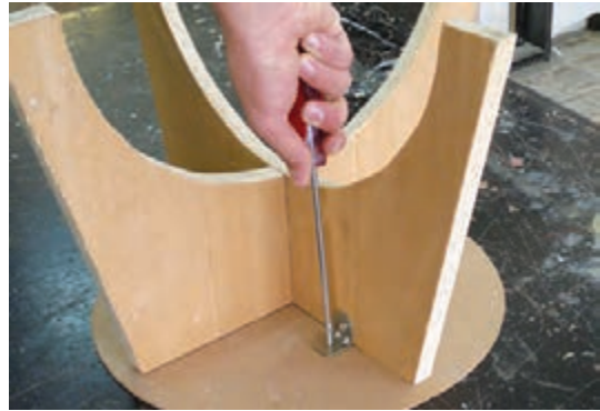
شکل ۶۷- مراحل مونتاژ چهارپایه
