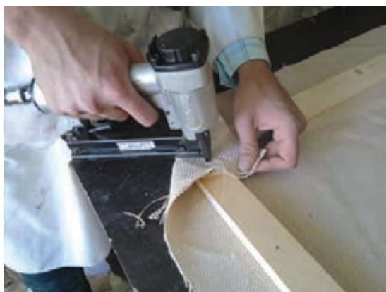
شکل ۳۲- منگنه زدن گوشه قاب
