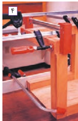
شکل ۲۷- مراحل مونتاژ میز جلوی مبل
