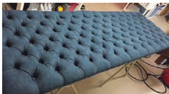
شکل ۷۱- لمسه کاری کامل دیوارپوش تزئینی
