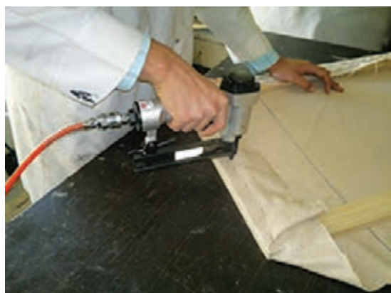
شکل ۳۶- منگنه زدن وسط قاب در ضلع دیگر
