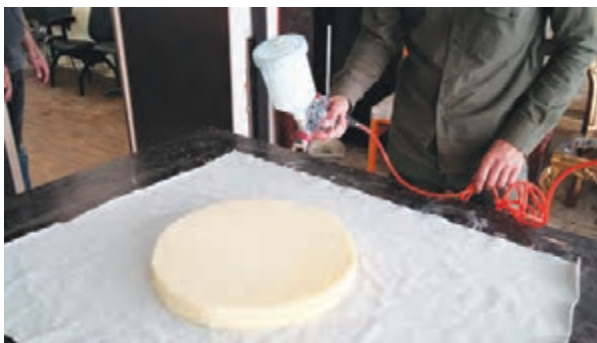
شکل ۸۷- پاشیدن چسب با پیستوله
