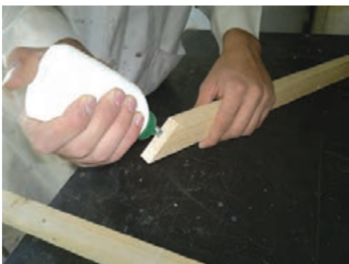
شکل ۲۴-چسب زدن سر قطعات
