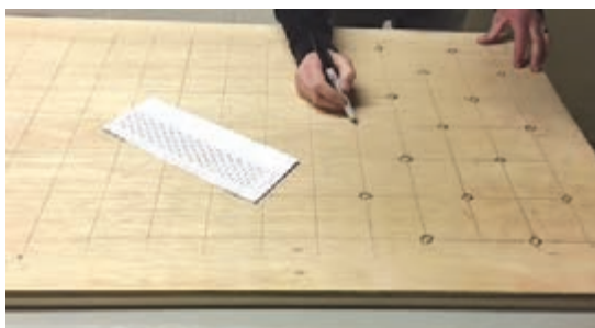
شکل ۴۸- علامت گذاری محل سوراخ‌ها با ماژیک
