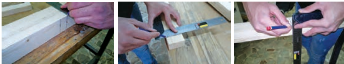
شکل ۴۴- خط‌کشی و انتقال اندازه‌ها به ضخامت چوب
