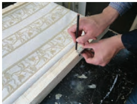
شکل ۶۸- خط کشی با استفاده از لولا
