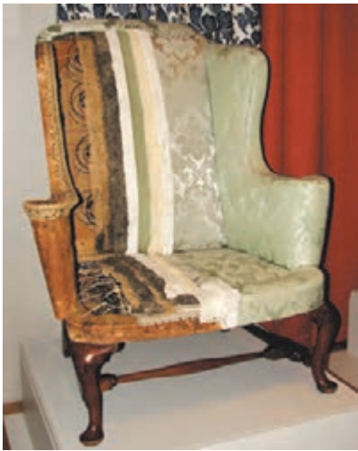
شکل ۶۹- مبلی برش خورده با فنرهای کف
