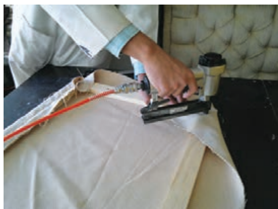
شکل ۳۵- منگنه زدن یک گوشه دیگر
