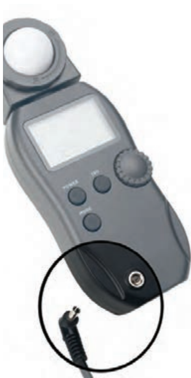
▲ تصویر ۱۹۴ سیم سینکرون و محل اتصال آن به نورسنج
