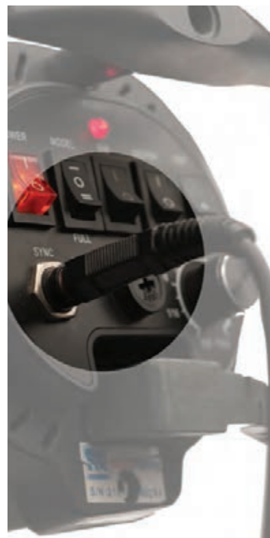
▲ تصویر ۱۹۶ | اتصال سیم سینکرون به فلاش
