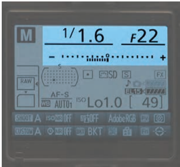
▲ شاخص نورسنج TTL دوربین عکاسی | تصویر ۵۶
