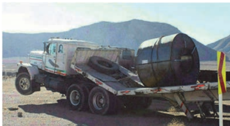
شکل ۲- عدم توزیع مناسب بار بر گروه‌های محوری
