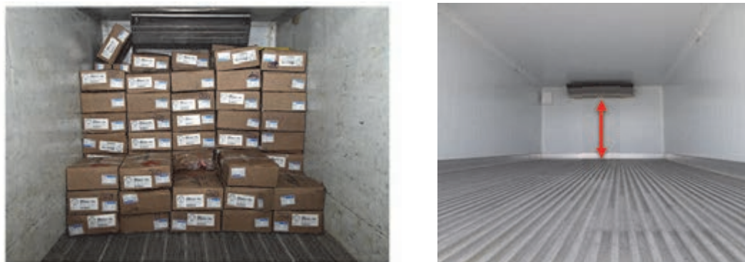
شکل ۲۴- نمایش حداکثر ارتفاع بارگیری
