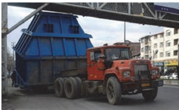
شکل ۱۹- مسیر نامناسب حمل بار ترافیکی
