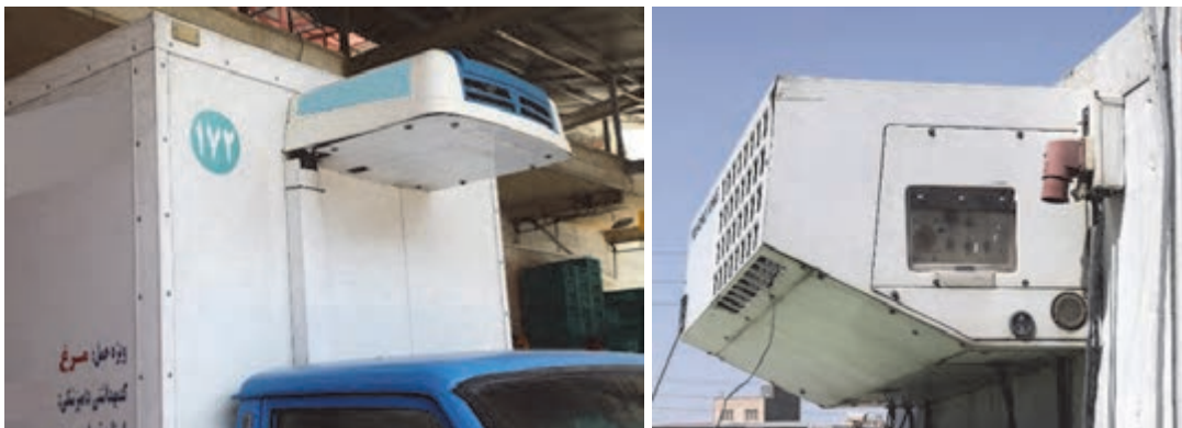
شکل ۲۱- تجهیزات سرمایشی نصب شده بر روی وسیله‌نقلیه
