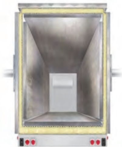
شکل ۷- اتاق عایق‌بندی شده
