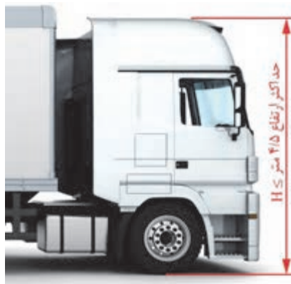
شکل ۴- حداکثر ارتفاع تعیین شده برای وسایل نقلیه
