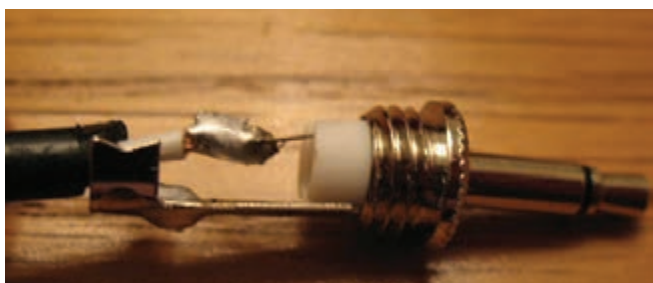
تصویر ۸۵- نقاط اتصال سیستم‌های نان سیمتریک
