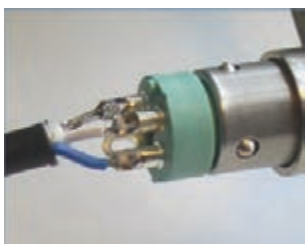
تصویر ۷۶- نقاط اتصال سیستم‌های سیم‌تریک
