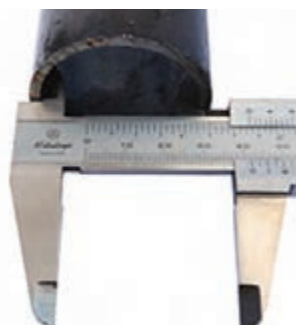
شکل ۴۸ - شاخک‌های داخل‌سنج کولیس
